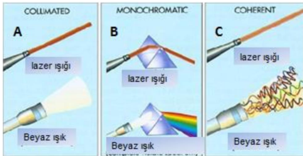
Şekil 2.1. A – Kolimasyon özelliği (dağılmama); B - Monokromatiklik (tek renkli olma); C – Koherent olma özelliği (aynı fazda olma) (212).
