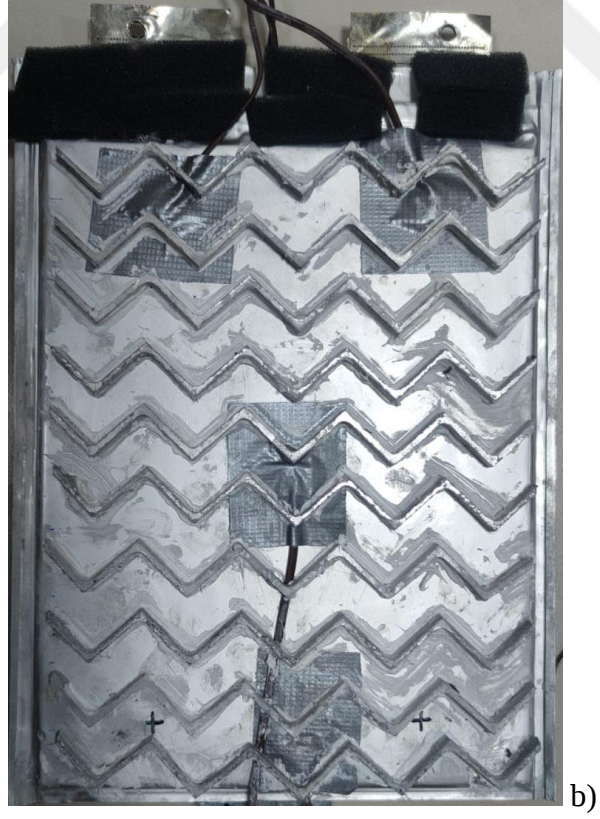
Şekil 4.5. Batarya Yüzeyindeki Sıcaklık Ölçüm Noktaları a) Kanatsız Geometri ve b) Kanatlı Geometri
