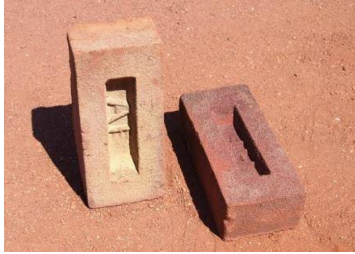
Şekil 5.21. 18,5 x 8,5 x 5,5 Ölçülerinde Tuğlalar
