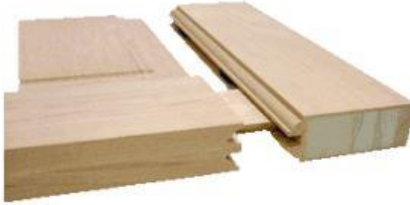
Şekil 5.12. Ahşap kapıların köşe birleştirme konstrüksiyonları
