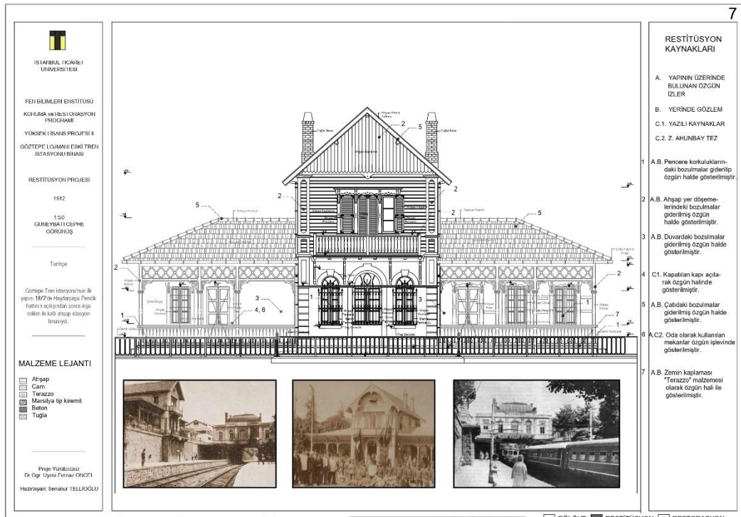
EK B, Güneybatı Cephe Görünüşü
