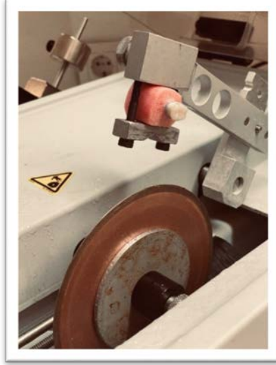
Şekil 3.19. Endokron restorasyonlardan kesitlerin alınması
