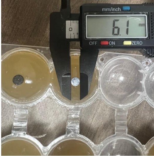
řekil 4: Dijital Kumpas ile disk aplarının doėrulanması
