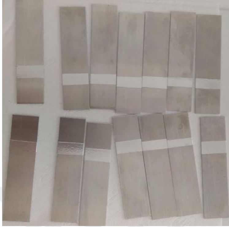
Şekil 3.3. Yapıştırma İşlemi Öncesi Alüminyum Levhaların Hazırlanması
