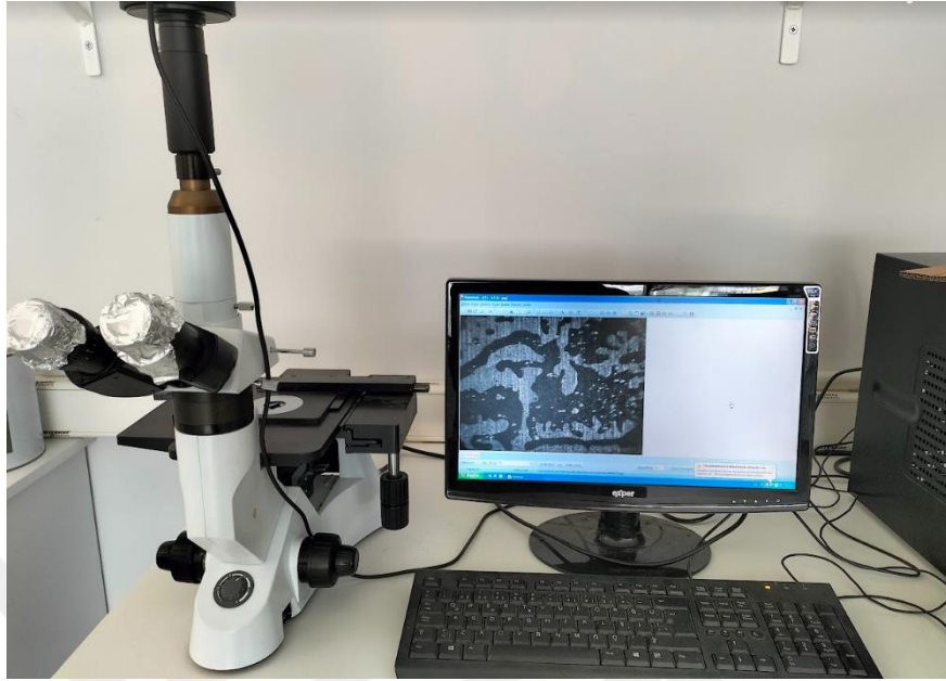
Şekil 3.13. Mikroskop ile Yapışma Yüzeylerinin İncelenmesi
