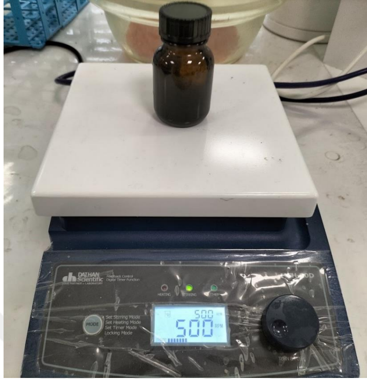
Şekil 3.1. Manyetik Karıştırıcı ile Yapıştırıcıların Hazırlanması Süreci
