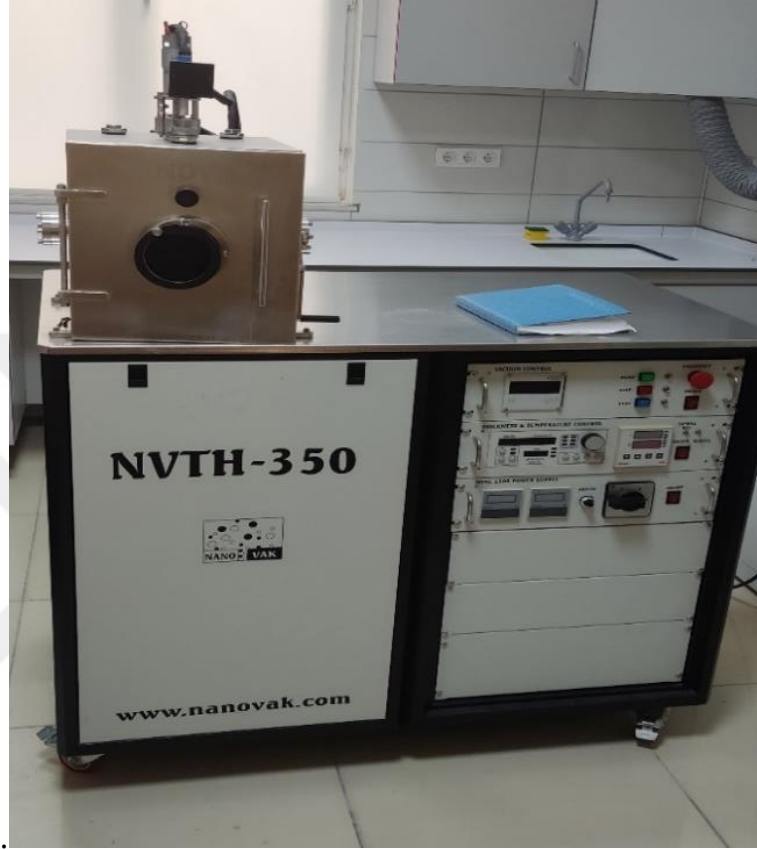
Şekil 4. 7. Al buharlaştırma ve kaplama kullanılan NVTH-350 model PVD cihazı.
