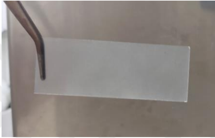
Şekil 4. 6. Cam üzerine oluşturulan TiO 2 ince tabaka.
