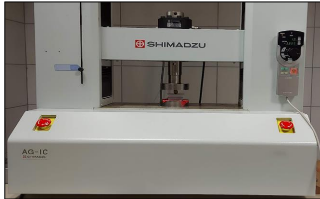
Şekil 2.5 : Türk fındığı tohumunda basınç testinin uygulanması
