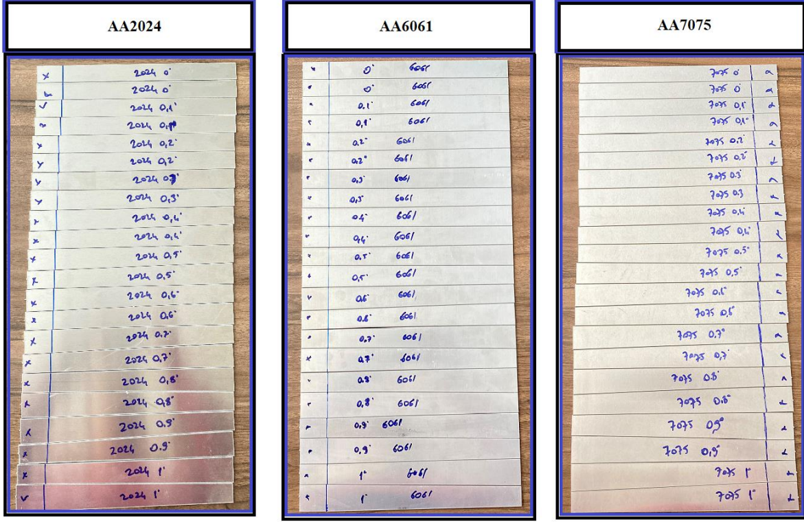
Şekil 4.6: AA2024, AA6061 ve AA7075 Al alaşımlarının su jeti ile kesim sonrası kesim açısı ve kesim yönü görüntüleri.
