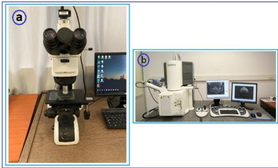
Şekil 4.12: Yüzey analiz işlemlerinde kullanılan cihazlar, a) 50X – 1000X büyütme oranına sahip optik mikroskop cihaz görüntüsü, b) Ayrıntılı yüzey analizi işleminde kullanılan FESEM analiz cihazı.
