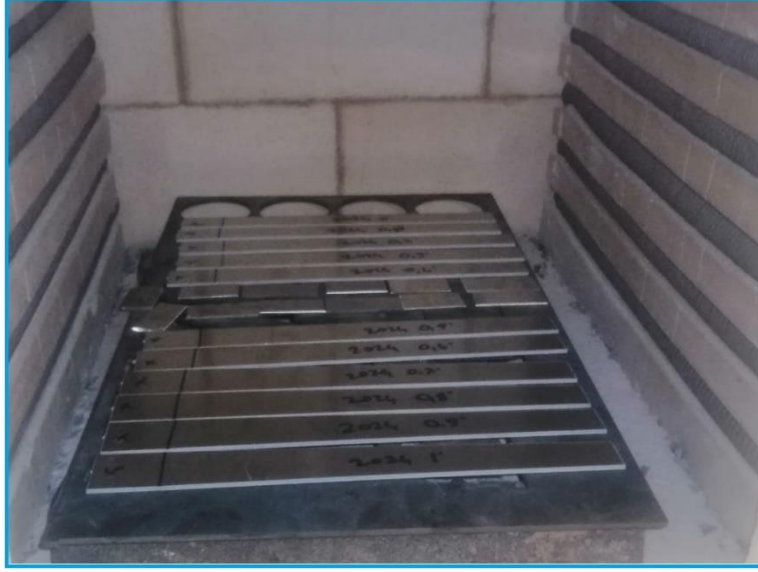
Yaşlandırma ısıtma işlem aşaması ( 160°)
