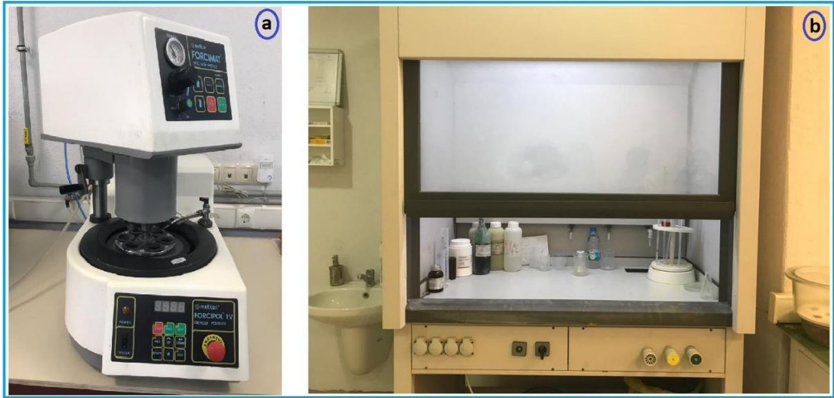
Şekil 4.11: Numune hazırlama ekipmanları, a) Otomatik zımpara parlatma makinesi, b) dağlama işleminde kullanılan çeker ocak.
