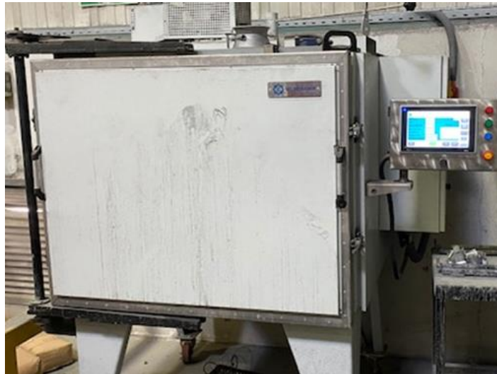
Şekil 3. 1. Laboratuvar tipi ısıtılma işlem fırını
