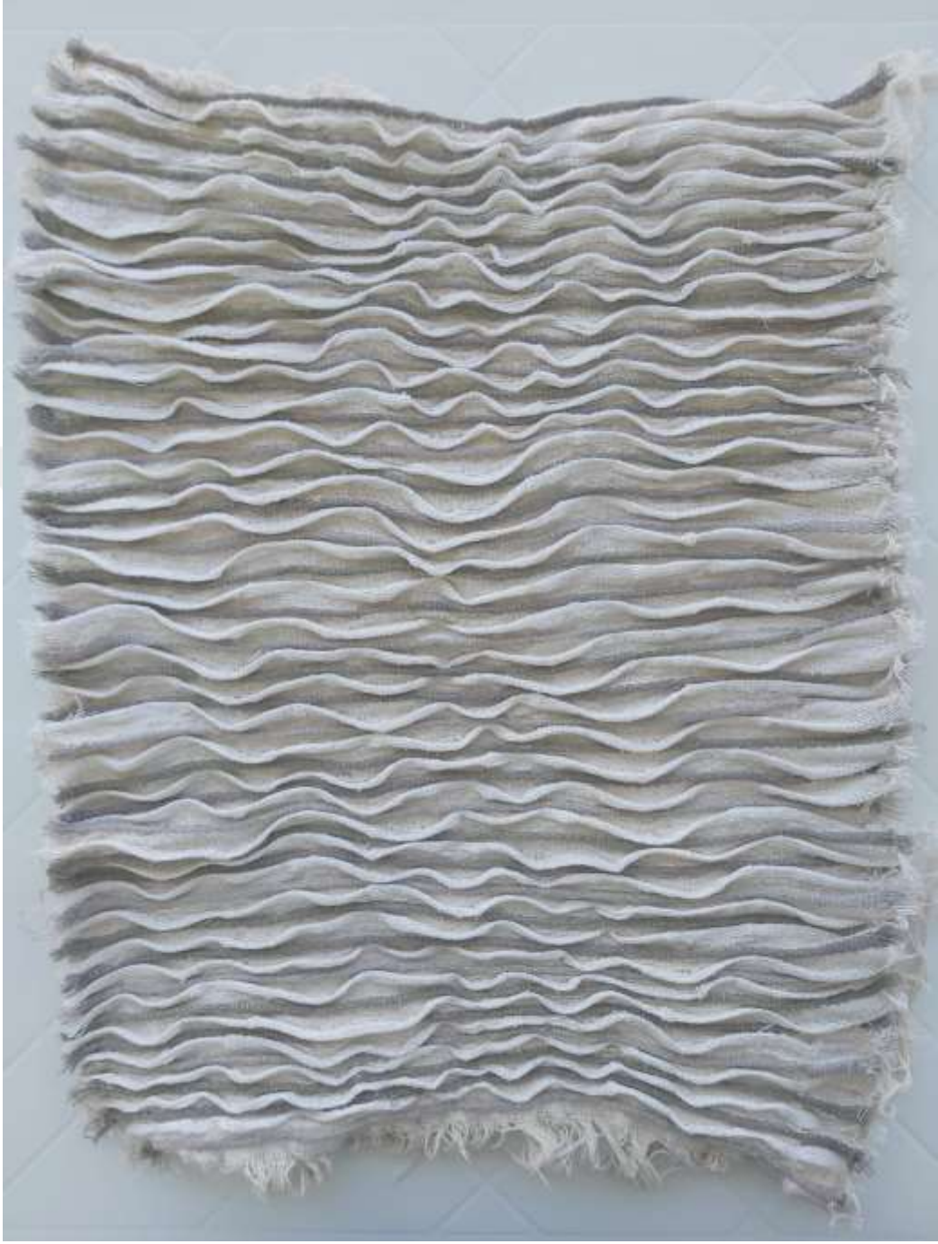
Şekil 59- Tasarım 5, Otomatik Dokuma Makinasında Dokunan Kumaş, Pilise İplikleri Çekilmiş Hali, Merve Soybaş, 2023
