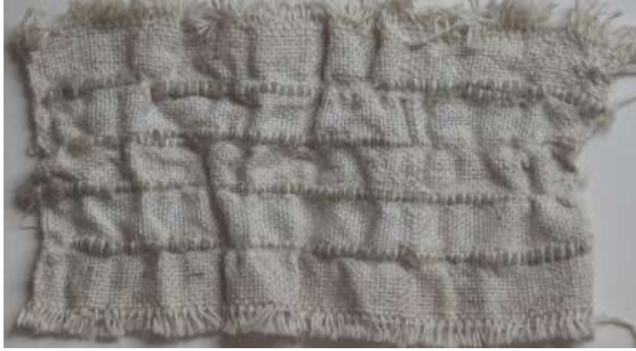
Şekil 33- Tek Katlı Hacimli Kumaş Çektirme İşlemi Sonrası
