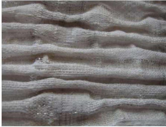
Şekil 25- Çift katlı yapı, tek katlı yapı, Dolgu Atkılı Yapı Deneysel Dokuma Kumaş, Havva Halaçeli (Halaçeli, 2009: 110)
