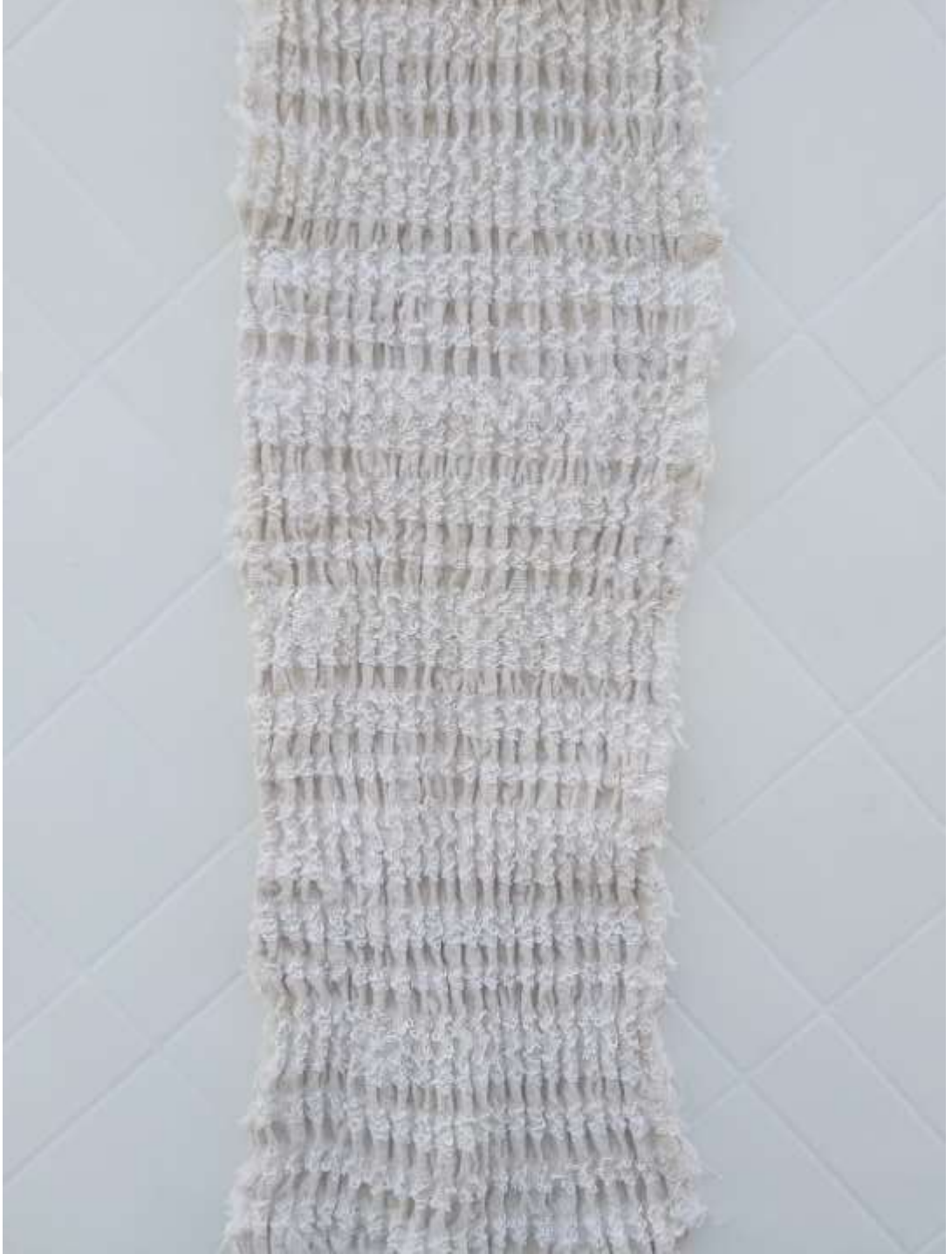
Şekil 57- Tasarım 4, Otomatik Dokuma Makinasında Dokunan Kumaş, Çektirme İşlemi Sonrası, Merve Soybaş, 2023
