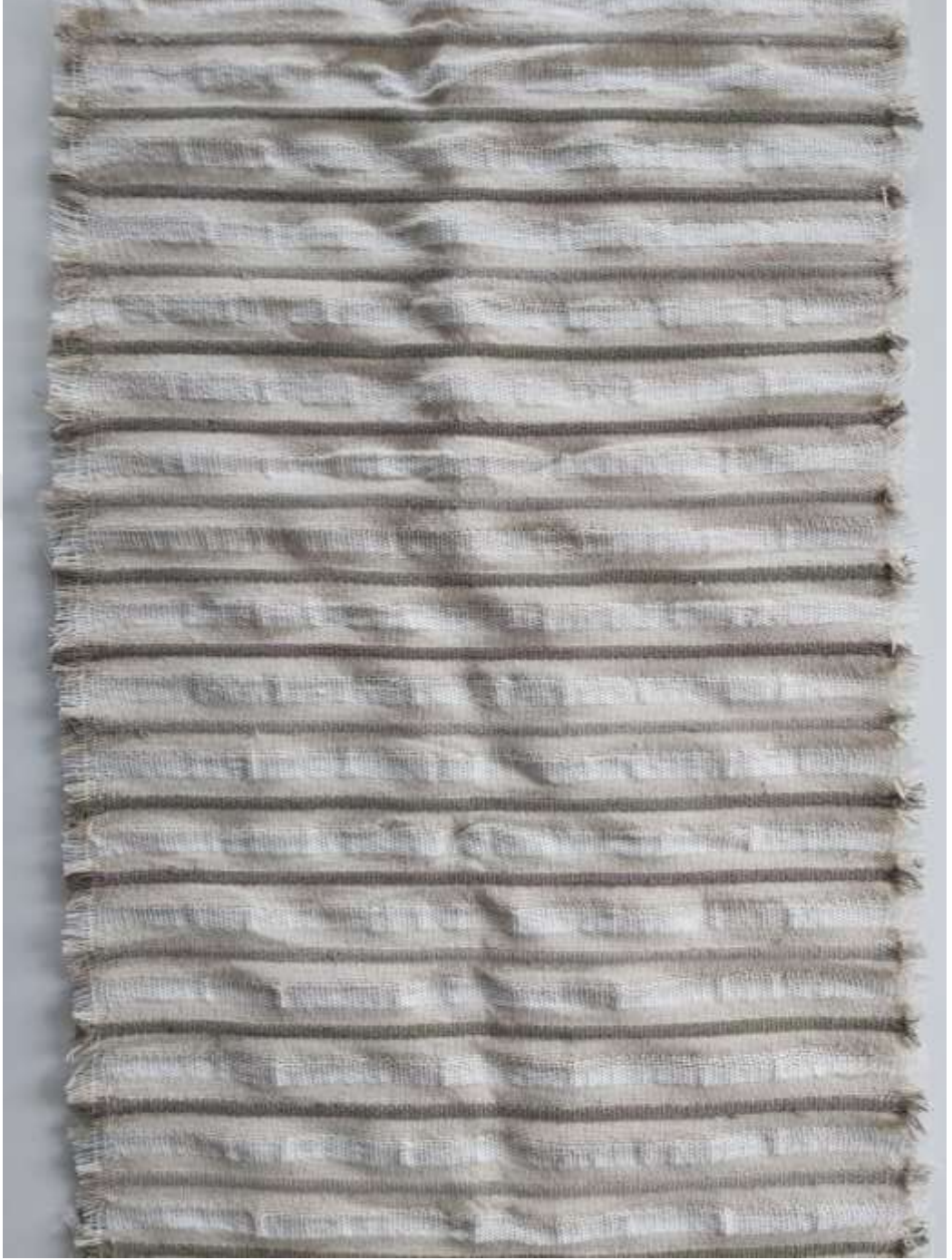
Şekil 58- Tasarım 5, Otomatik Dokuma Makinasında Dokunan Kumaş, Merve Soybaş, 2023
