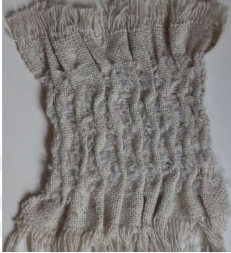
Şekil 36- Atkı Lanseli Yapı Uygulamalı Hacimli Kumaş
