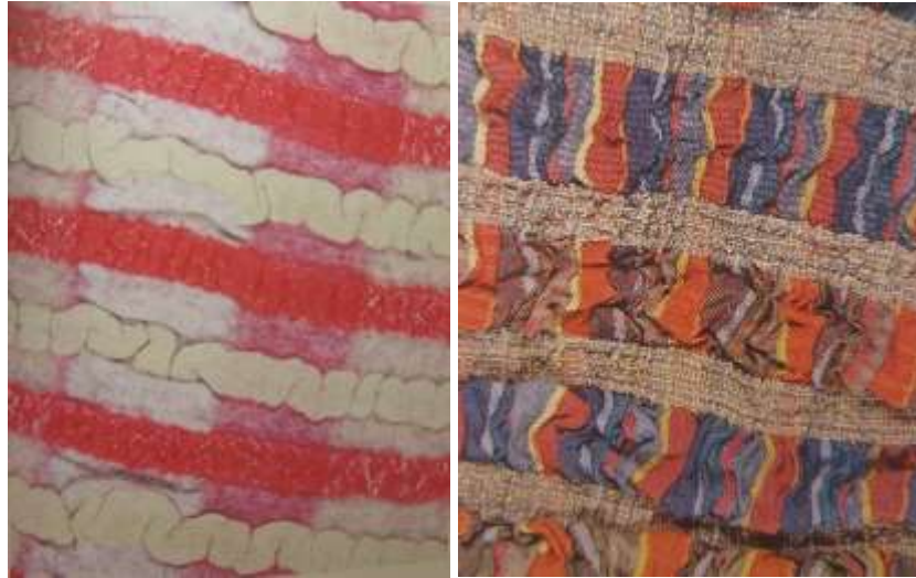
Şekil 24- Çift Kat Yapılı Dokuma Kumaş Pamuk-Yün Karışımı (a), Çift Kat Yapılı Dokuma Kumaş, İpek, Keten ve Elastik İplik (b), (Shenton, 2014: 185)
