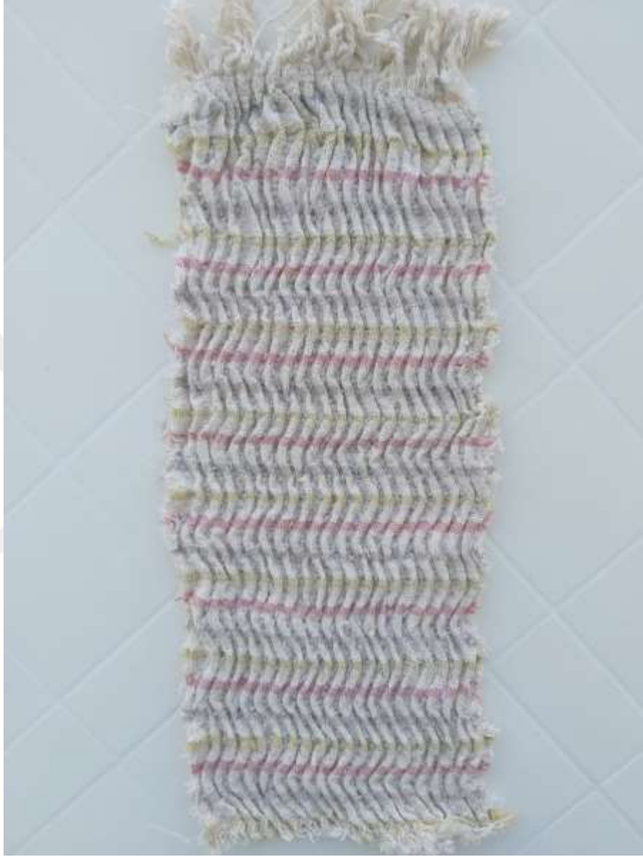
Şekil 55- Tasarım 1, Otomatik Dokuma Makinasında Dokunan Kumaş, Çektirme İşlemi, Merve Soybaş, 2023
