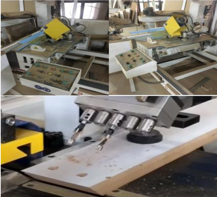
Resim 2. 7: Kapı Kasası Gönye Makinesi ve İş Parçası Örneği
