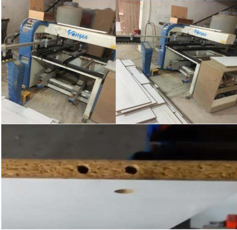
Resim 2. 5: Çoklu Delik Delme Makinesi ve İş Parçası Örneği
