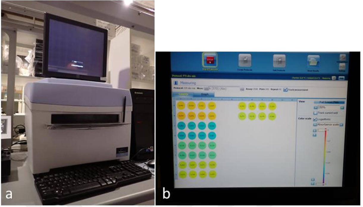
Şekil 24. a. PerkinElmer Enspire multimode plaka okuyucu, b. Plakaların okutulması sonucu elde edilen absorbans değerleri
