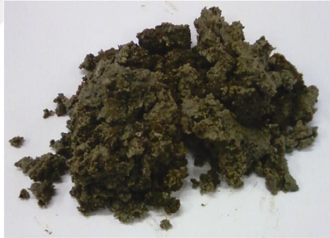
Şekil 10. ANPHOS prosesi neticesinde elde edilen strüvit (Langeveld, 2019)
