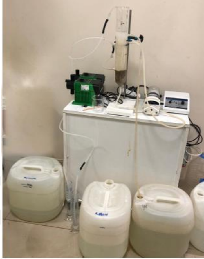
Şekil 13. Çalışmada kullanılan akışkan yataklı reaktörün görünümü
