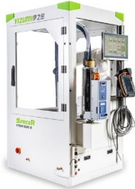
Şekil 2.6 : Yizumi SpaceA-900-500-S kodlu üç boyutlu yazıcı
