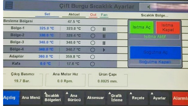
Şekil 2.4 : Karışım malzemesi imalatında kullanılan çift vidalı ekstrüderin proses parametreleri
