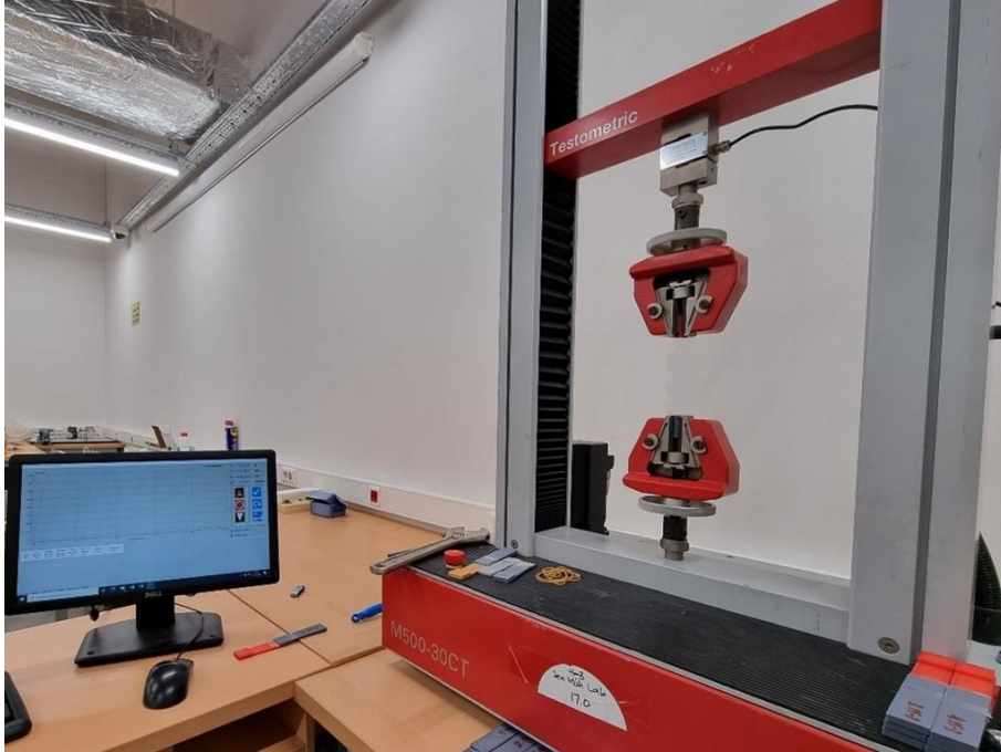
Şekil 4.2 : Testometric markalı çekme makinesi
