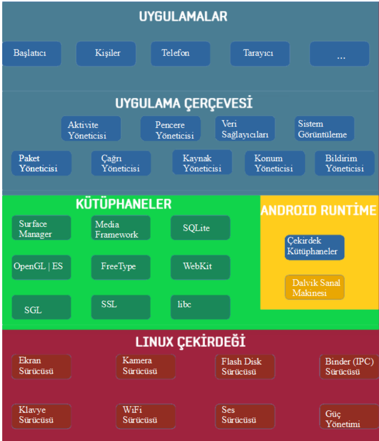
Şekil 4. 2. Dalvik sanal makinesi ile çalışan Android sistem mimarisi. Yeşil nesneler C/C++ dili ile yazılmış olup, mavi nesneler Java ile yazılmış ve Dalvik sanal makinesi ile çalışmaktadırlar (Brahler, 2010).
