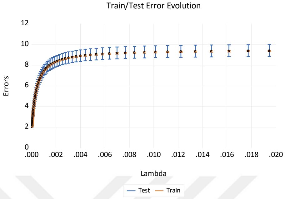
Şekil 36. Ham veri erkek datasetinde Elastik net model sonucunda eğitim ve test verisinin lambda değerlerine göre hata grafiği
