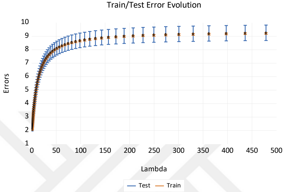
Şekil 34. Ham veri erkek datasetinde Ridge model sonucunda eğitim ve test verisinin lambda değerlerine göre hata grafiği
