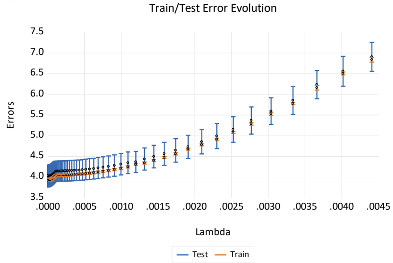
Şekil 71. Türetilmiş veri kız datasetinde Lasso model sonucunda eğitim ve test verisinin lambda değerlerine göre hata grafiği
