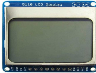
Şekil 3.8. Arduino uyumlu Nokia 5110 LCD 84x48 Modül
