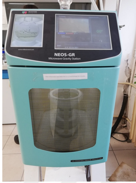
Şekil 3.3: Mikrodalga Destekli Ekstraktör (NEOS-GR, Milestone Srl, Italya)
