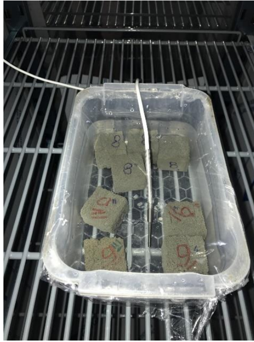
Şekil 3.20. Numune boylarını 3-5 mm aşacak kadar musluk suyu ile doldurulan kap
