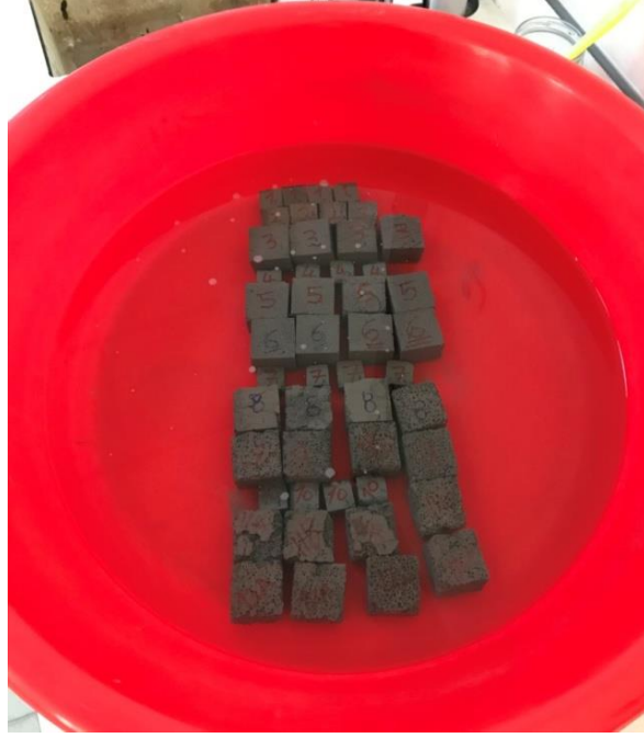
Şekil 3.18. Kovada su içinde bekletilen numuneler
