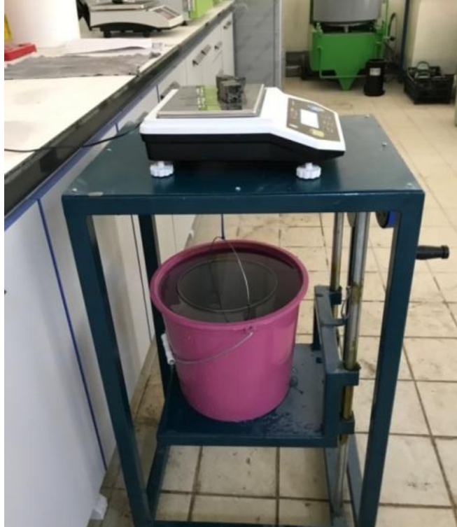
Şekil 3.19. Arşimet deney düzeneği
