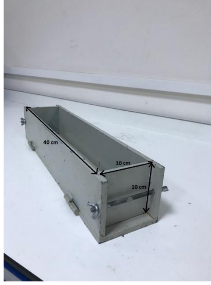
Şekil 3.10. Deneysel çalışmada kullanılan 40*10*10 cm 3 kalıp
