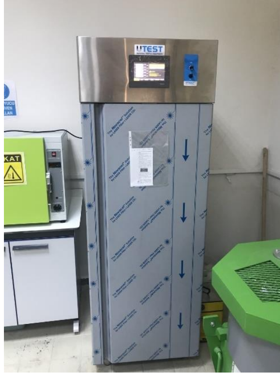
Şekil 3.21. Utest Metarial Testing Equipment marka donma çözünme kabini
