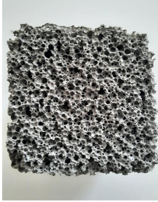
Şekil 3.16. Ana malzemeden kesilerek oluşturulan küp numune
