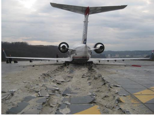
Şekil 1.17. EMAS tarafından durdurulan bir uçak
