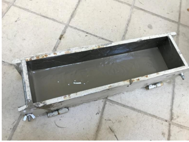
Şekil 3.12. Kalıba dökülmüş taze geopolimer hamur
