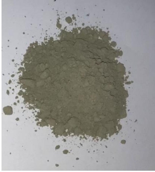
Şekil 3.2. Çalışmada kullanılan Çatalaęzı Termik Santrali F sınıfı uçucu külü
