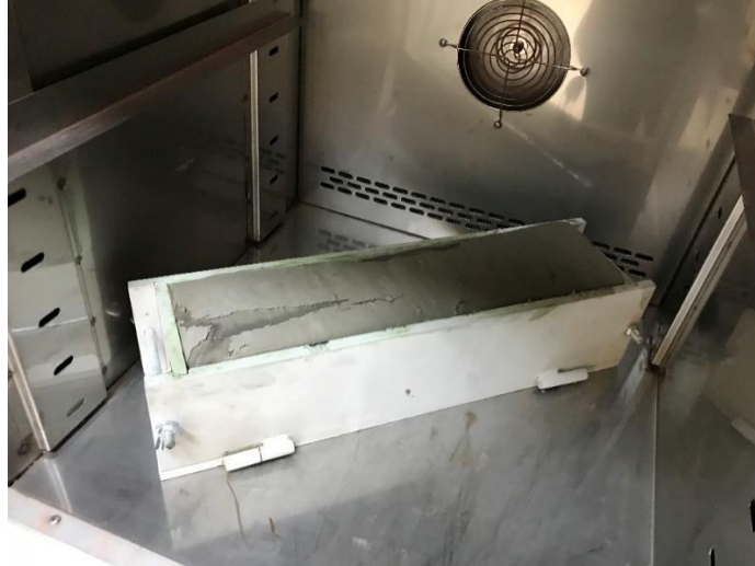
Şekil 3.13. Etüv içerisine konulan geopolimer malzeme
