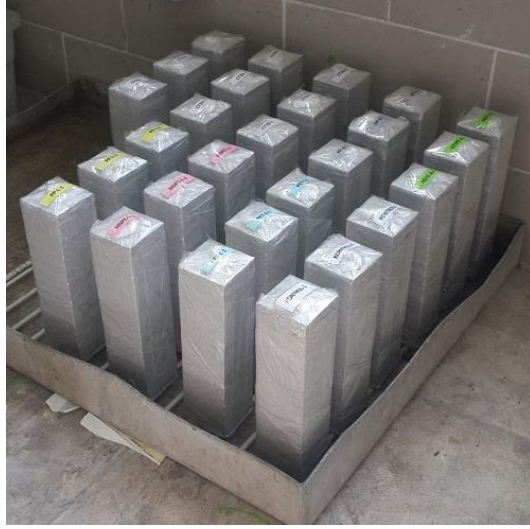
Şekil 3.13 Kılcal su emme deneyi
