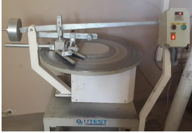
Şekil 3.14 Yüzeysel aşındırma (böhme) cihazı
