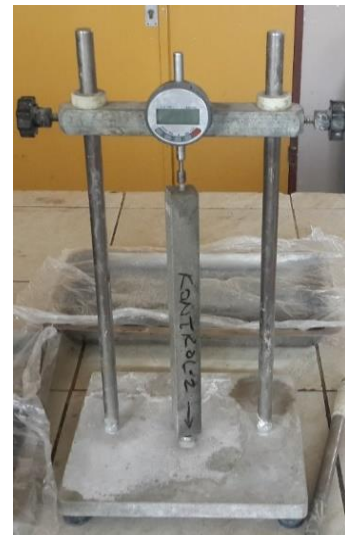
Şekil 3.17 Dijital komparatör ile boy değişimi ölçümü
