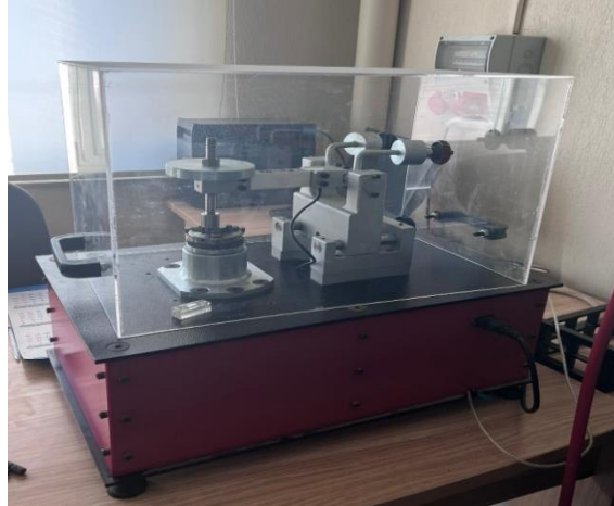
Resim 3.8 Aşınma cihazının görünüşü.
