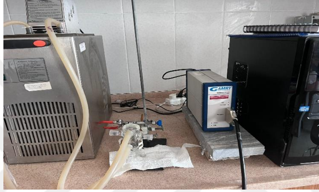
Resim 3.9 Elektrokimyasal Korozyon deney düzeneği.
