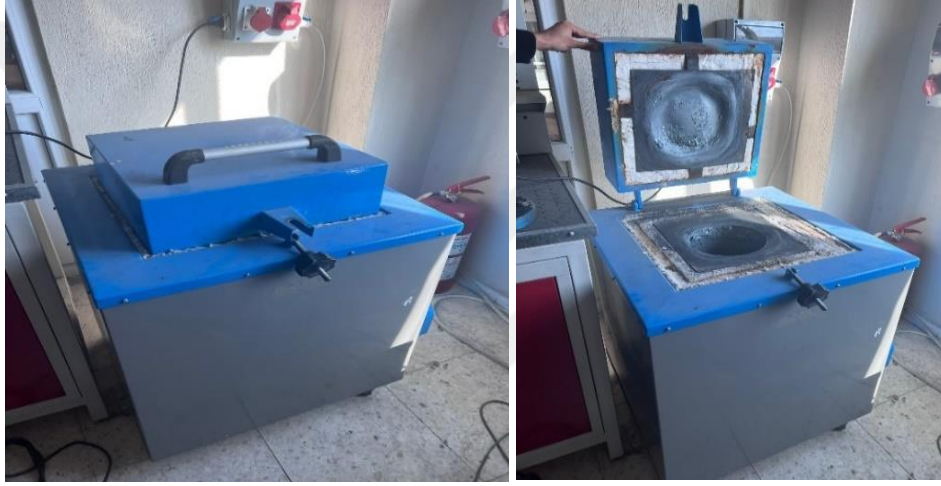
Resim 3.3 Borlama işleminde kullanılan fırının fotoğrafı.
