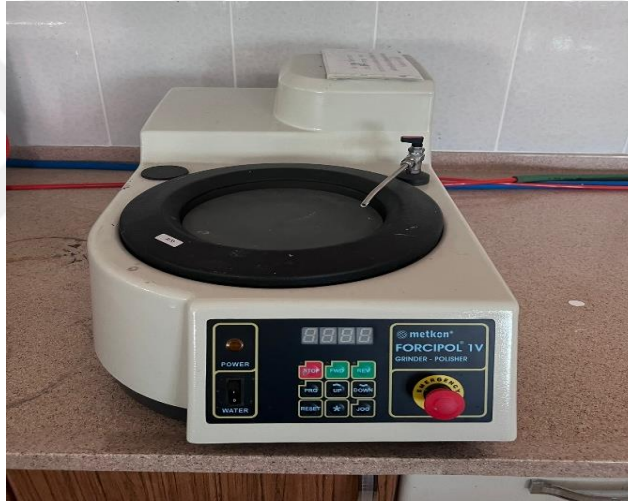
Resim 3.1 Numune zımparalama ve parlatma cihazı.
