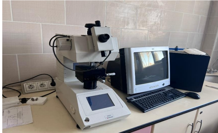
Resim 3.7 AISI 1040 çeliğinin sertlik değerlerinin alındığı mikro-sertlik cihazı.
