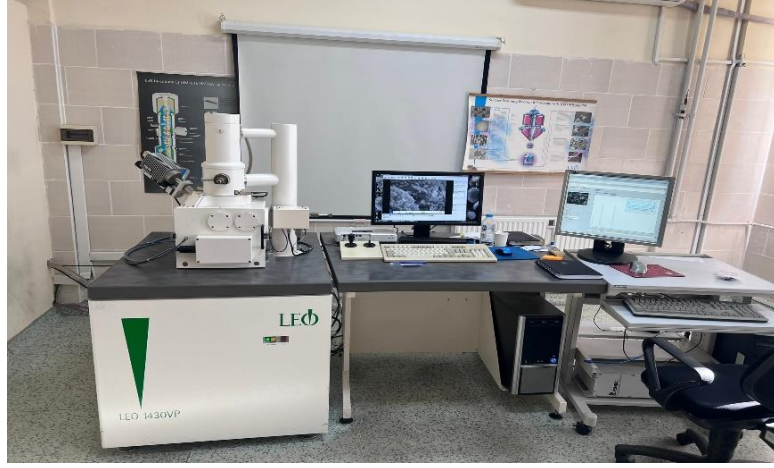
Resim 3.6 Tabaka kalınlığı belirlemek ve aşınma izi karakterizasyonu için kullanılan taramalı elektron mikroskobu.
