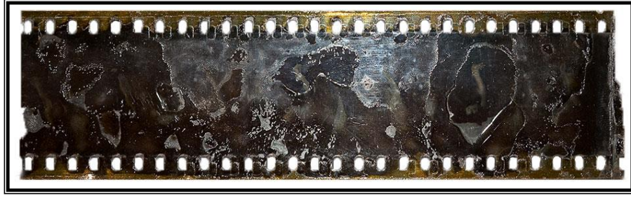
Resim 3.14. Jelatin Tabakası Bozulan Film 23
