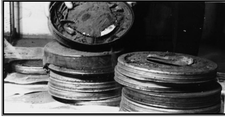
Resim 3.7. Toz Halini Almış Nitrat Film
