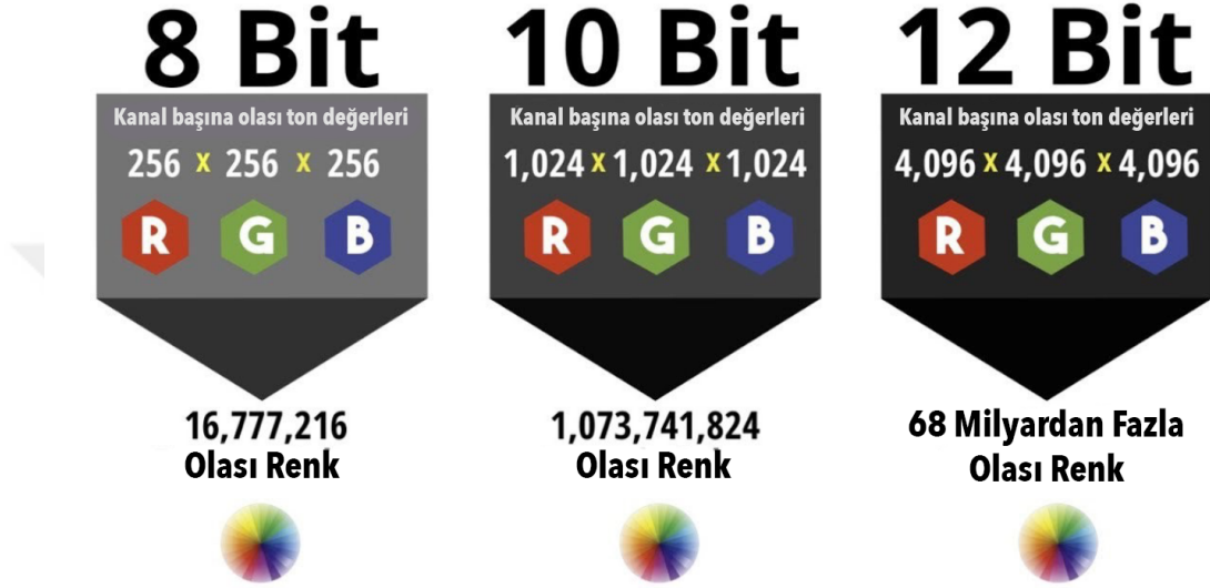
Şekil 19. Renk Derinlikleri ve İçerdikleri Ton Miktarları (Aldred 2018)
