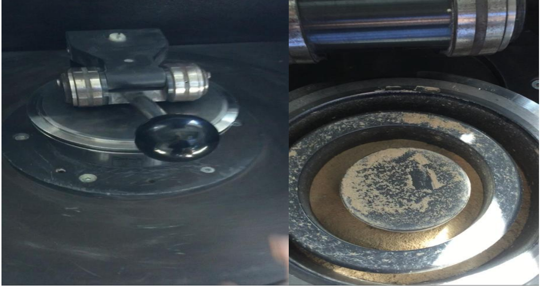
Fotoğraf 6. Titreşimli Diskli Öğütücü ile Yüksek Alaşımlı Kap içerisindeki Kayaç Numunesinin Tozlaştırma işlemi
