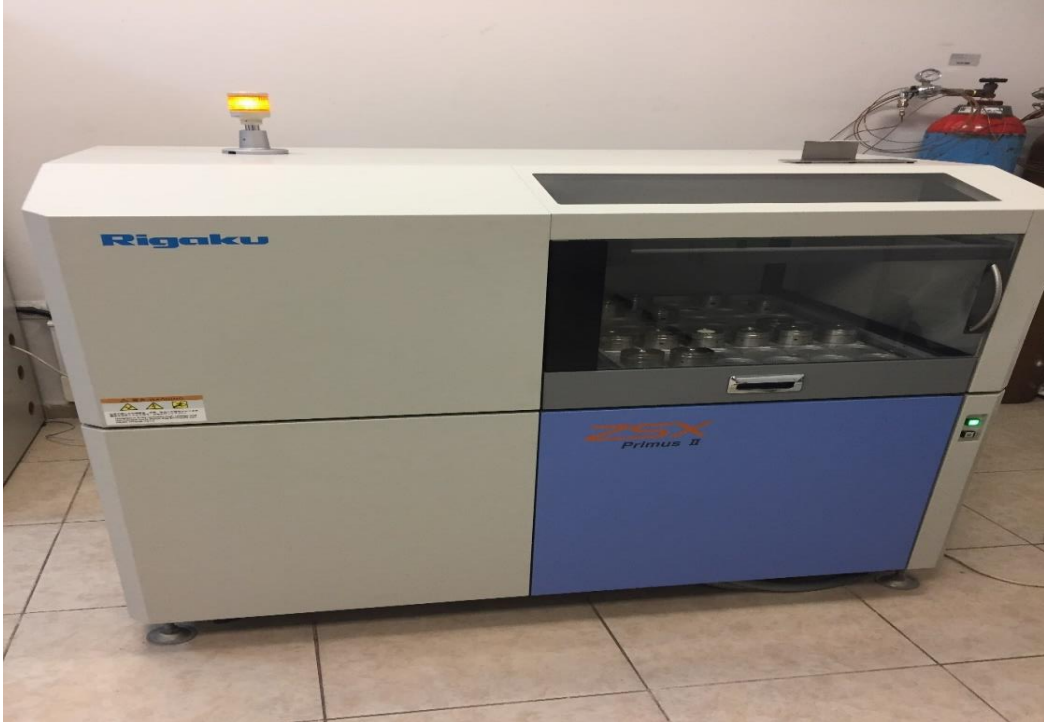
Fotoğraf 4. Rigaku Primus II X-ray Spektrometre
