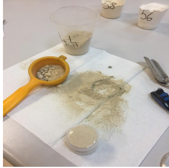
Fotoğraf 9. Numuneyi Eleme İşlemi
