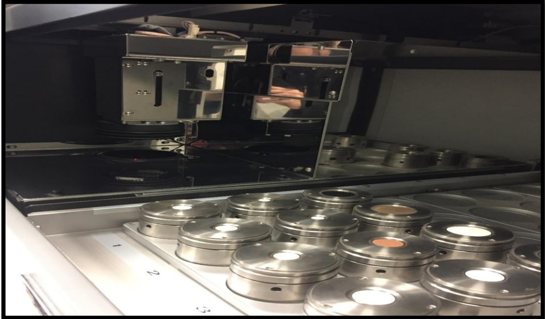
Fotoğraf 7. XRF Cihazın İç Bölümü
