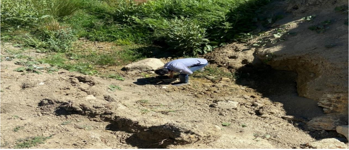
Fotoğraf 217. Sahanın Anakayasında Sızan Suyun TDS Ölçümü
