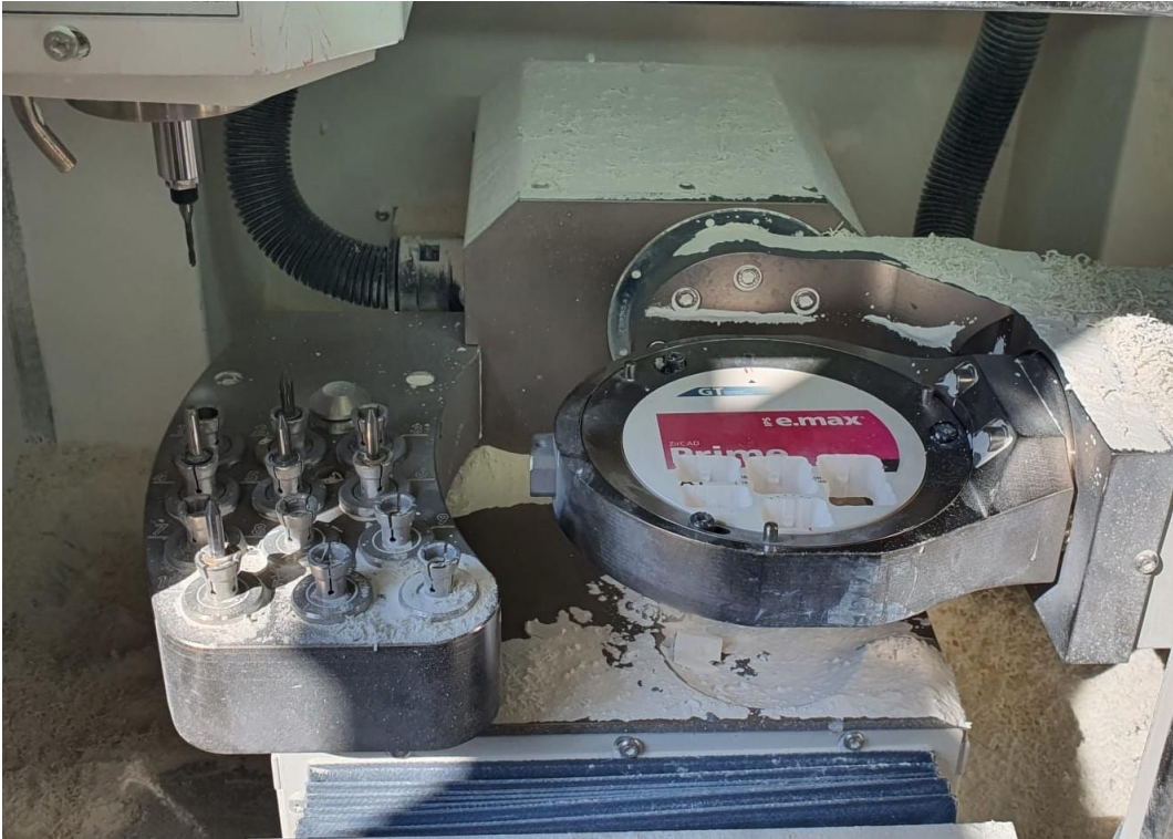
Şekil 2.4. CAM cihazında IPS e.max ZirCAD Prime (Ivoclar Vivadent) zirkonya diskten kesitlerin elde edilmesi.
