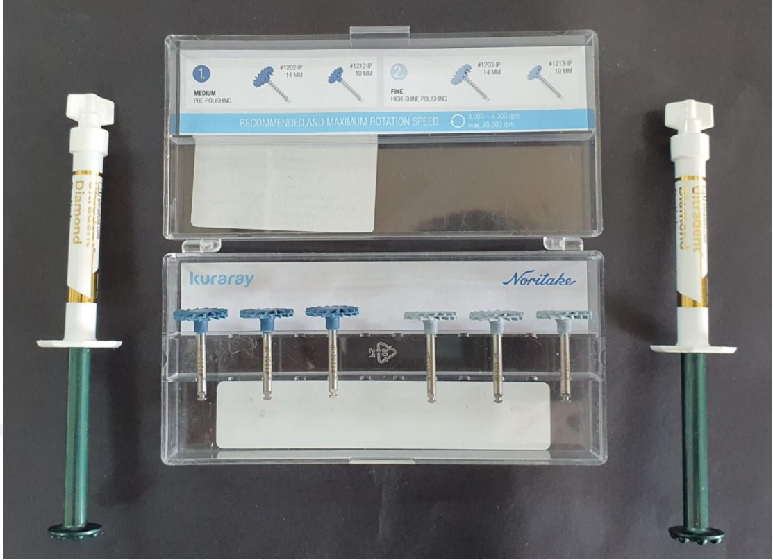
Şekil 2.6. Seramik örneklerin polisajı için kullanılan pat ve polisaj lastiği.
