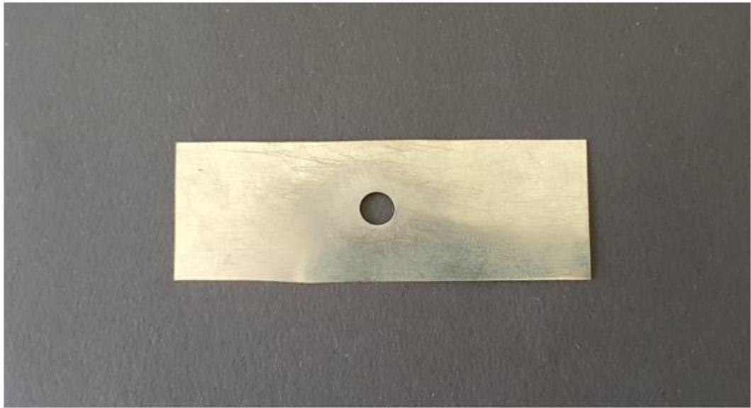
Şekil 2.9. Merkezinde 5 mm çapında delik (hazne) bulunan krom levha.
