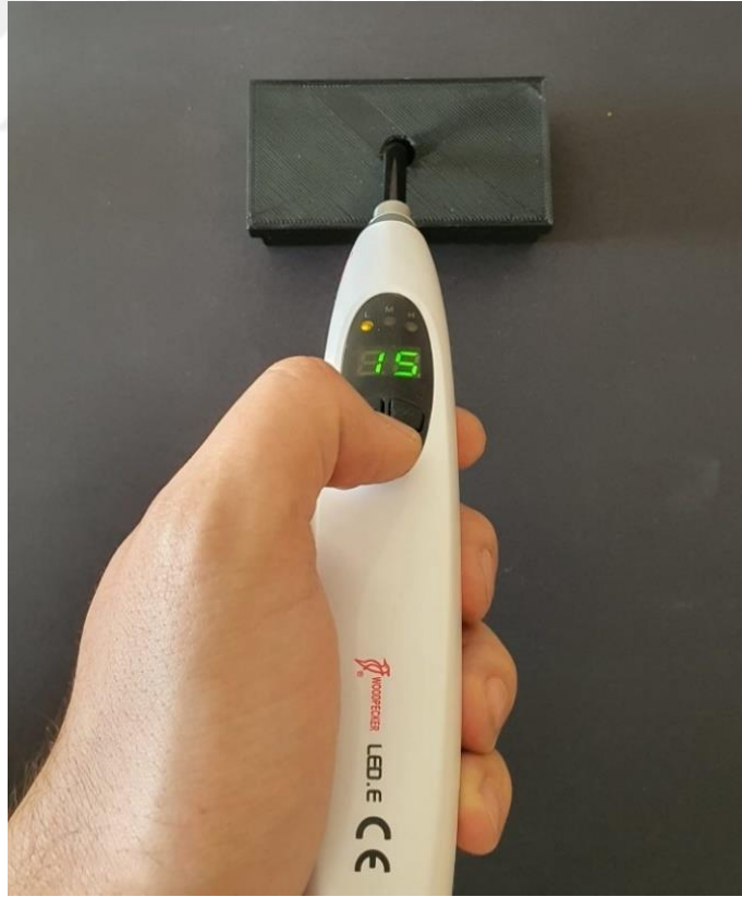
Şekil 2.11. Karanlık kutu ortamında LED ışık cihazı yardımıyla polimerizasyon işleminin yapılması.
