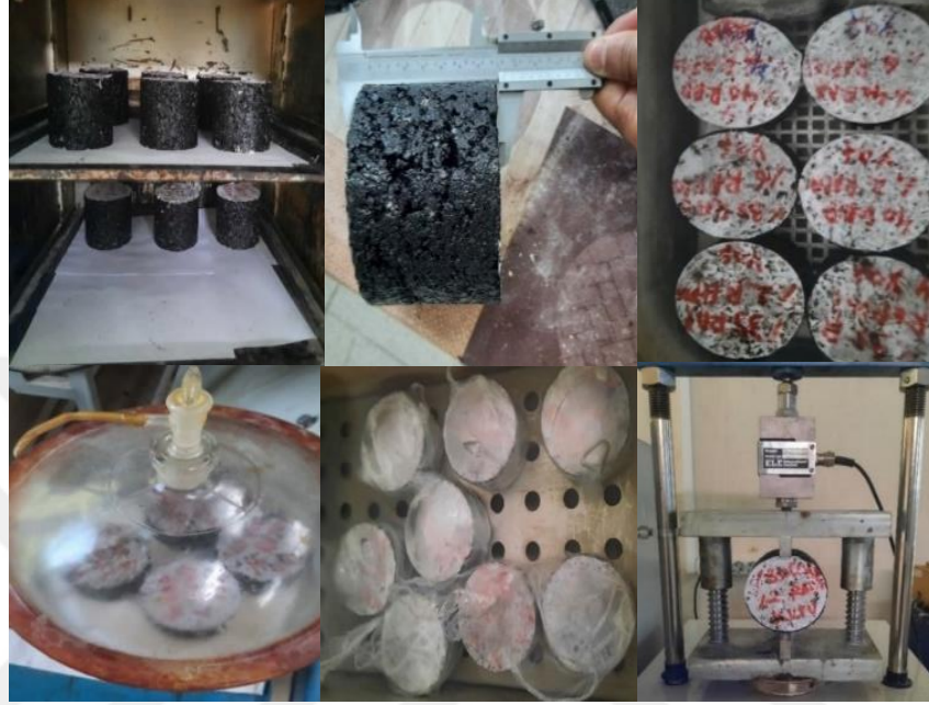
Şekil 4.11. Nem hassasiyetinin belirlenmesi için gerçekleştirilen adımlar
