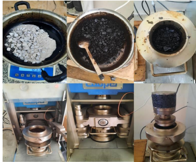
Şekil 4.10. Superpave yöntemiyle numunelerin hazırlanma aşamaları
