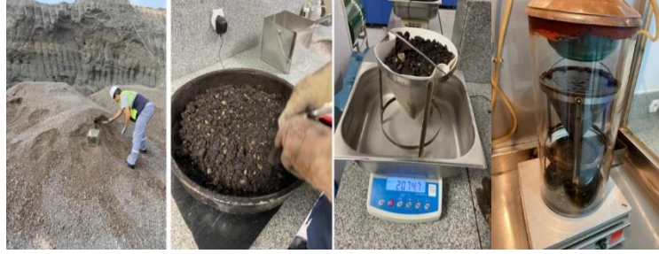
Şekil 3.2. RAP malzemesine uygulanan ekstraksiyon deneyi
