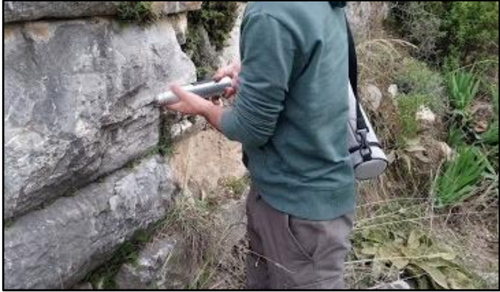
Res. 147: Taş malzeme analizleri için örnek alınmadan önce yapılan, schmidt çekici testi.
