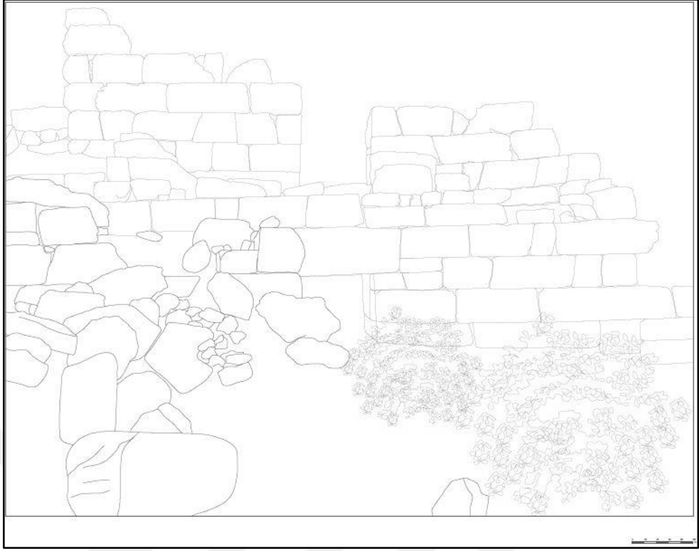
Çizim 12: B lb l Dağı batı surları 2 katlı kule, d z s ve blokları ile yapılmıř kare formunda kapıların detay r l ve  izimi. ( izen: B.  st n).
