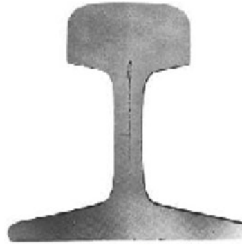
Şekil 2.6 : Boyuna dikey çatlak (Öztürk, 2010)
