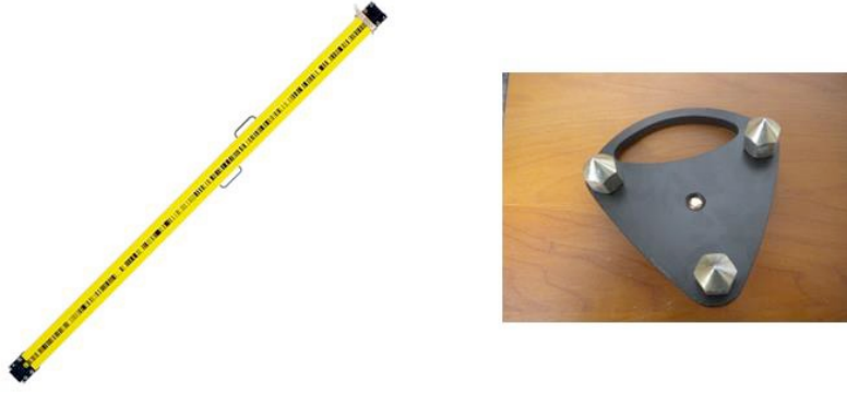
Şekil 5.4 İnvar mira ile mira altlığı (Doğan 2019).
