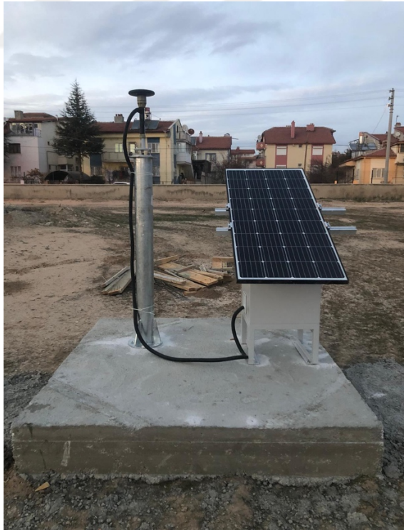
Resim 6.4 BMET sabit GNSS istasyonu (Bolvadin Meteoroloji Müdürlüğü bahçesi).
