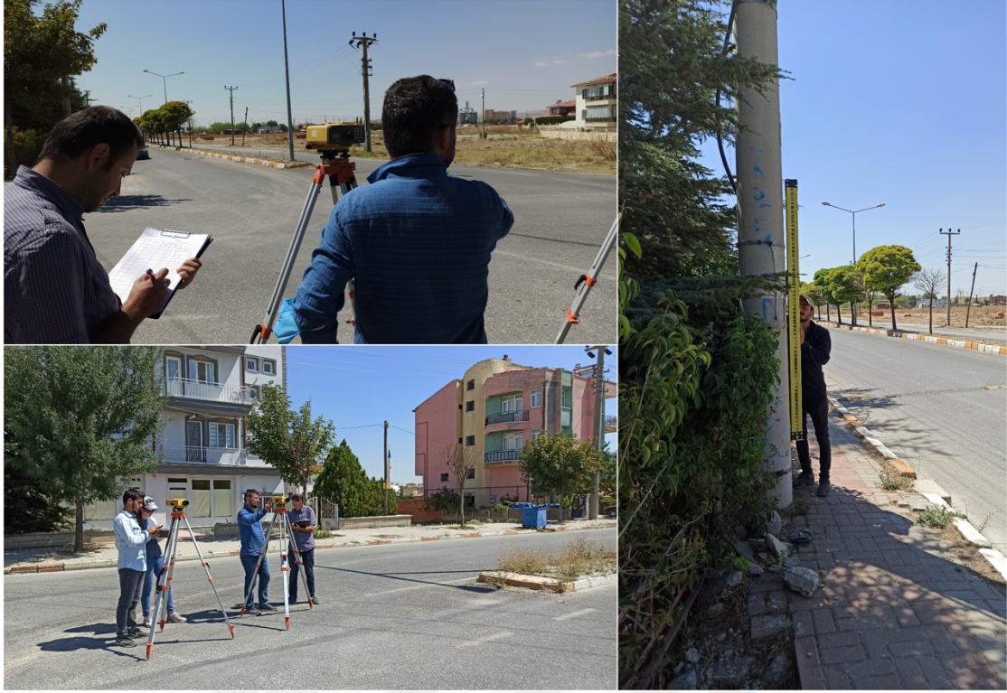
Resim 6.7 Bolvadin ilçesinde 2020 yılında yapılan nivelman ölçümleri.
