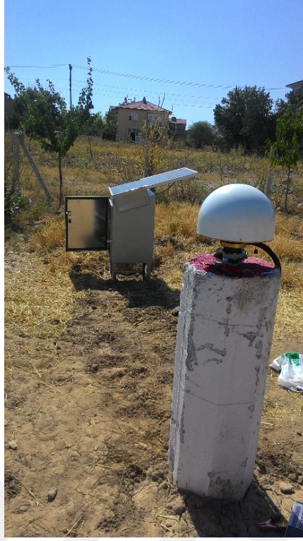
Resim 6.2 BLV1 sabit GNSS istasyonu (Bolvadin’de şahıs bahçesi).
