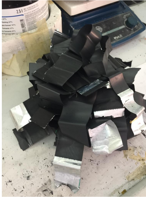
Şekil 3.2. Pillerden elde edilen katot plakaları.
