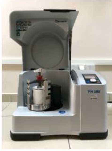
Şekil 3.4. Mekanokimyasal çözümlendirme deneylerinin gerçekleştirildiği gezegensel tip bilyeli değirmen.
