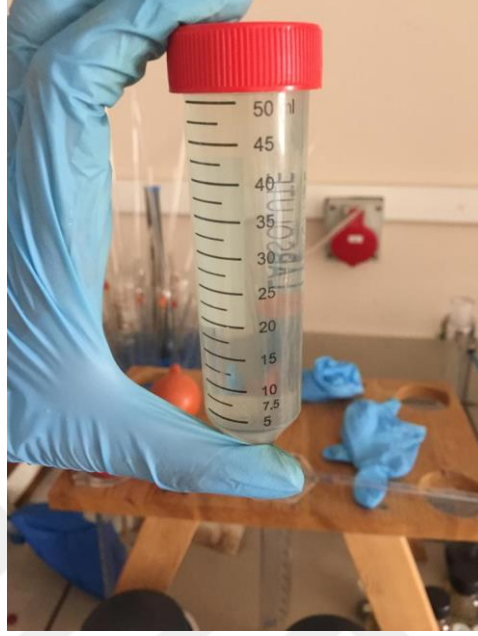
Şekil 3.6. Santrifüj işleminden sonra elde edilen katot tozu- \text{H}_2\text{C}_2\text{O}_4 özeltisi
