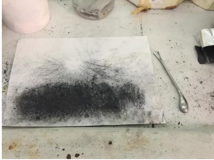
Şekil 3.3. Katot plakalarından kazıma ile ayrıştırılmış katot tozları.
