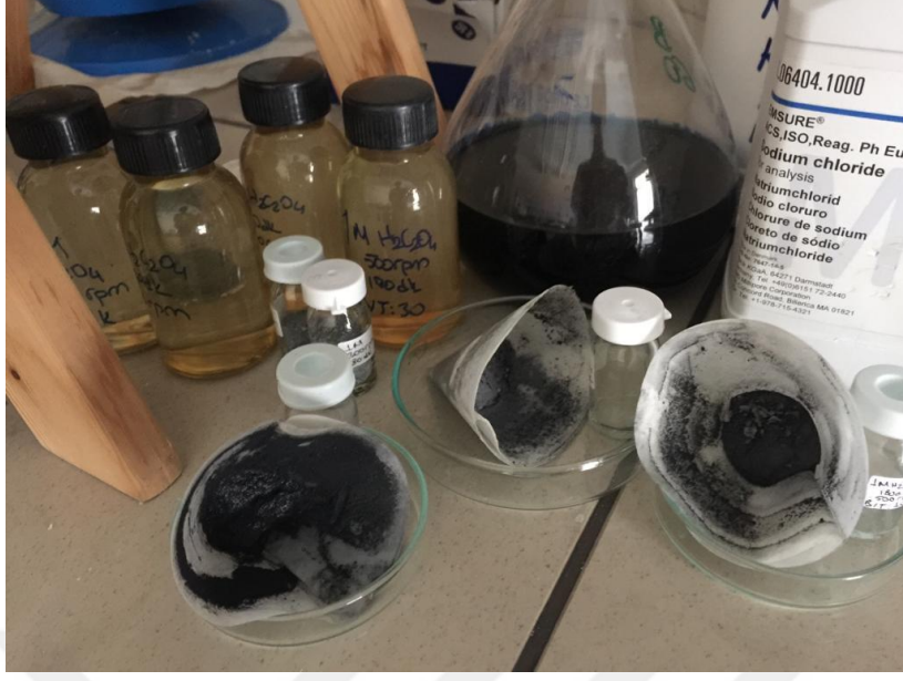
Şekil 3.8. Süzgeç kağıdına çökelen lityum atığı.
