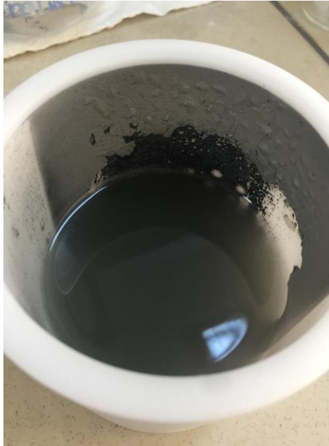
Şekil 3.5. Mekanokimyasal liç sonrası katot tozu- \text{H}_2\text{C}_2\text{O}_4 çözeltisi.
