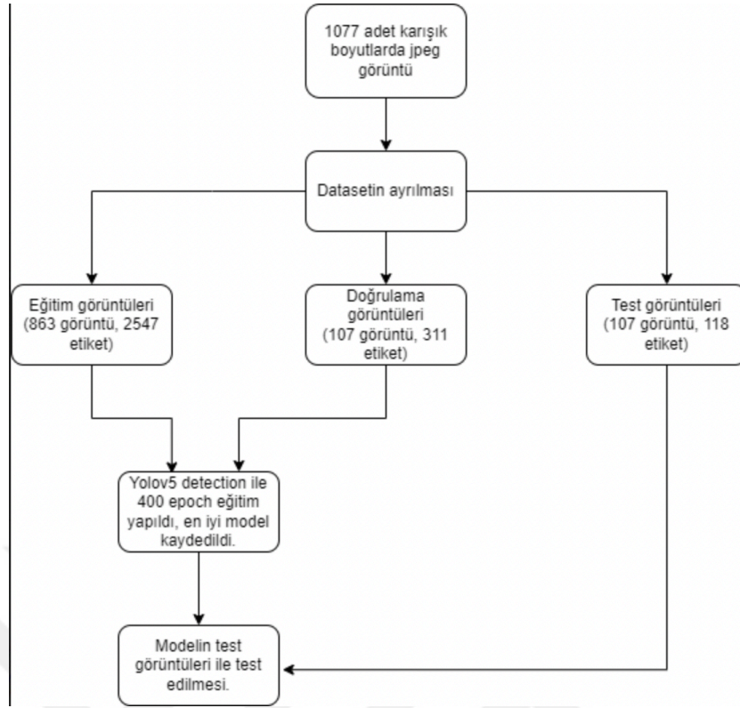
Şekil 3.10. YOLOv5x-seg modeli ile gerçekleştirilen vertebra segmentasyonu modelinin diyagramı
