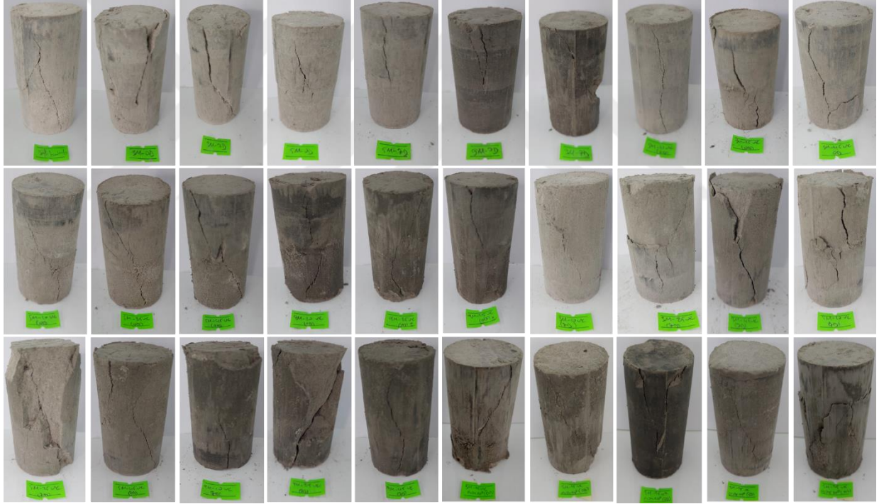
Şekil 6.30. Zemin numunelerinin kirlenme-kürlenme derecelerine ve sürelerine göre kırılma modları
