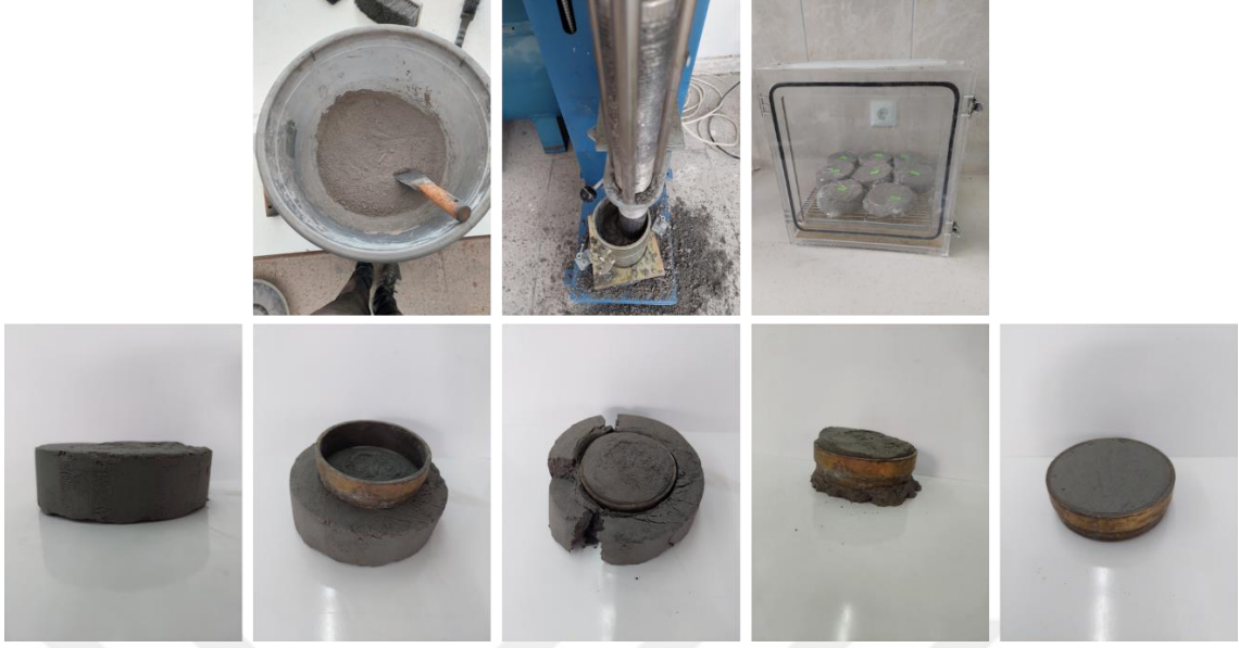
Şekil 5.18. Konsolidasyon deneyi için numune hazırlama aşamaları
