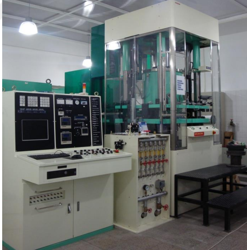
Şekil 5.1: Kompozitlerin üretiminde kullanılan Syntex 7.40 MK VII SPS sistemi.
