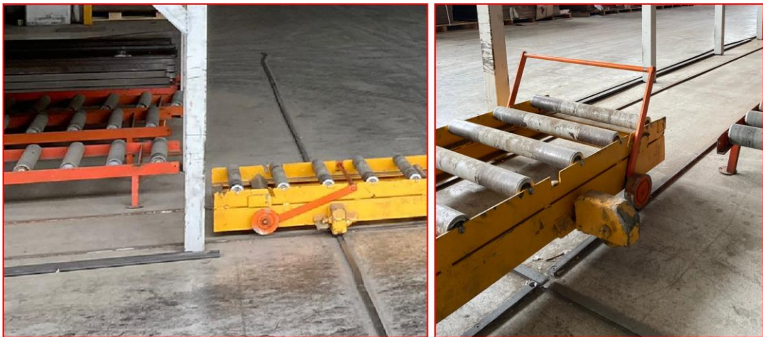
Şekil 4.37 : Hareketli konveyör yatay hareket mekanizması
