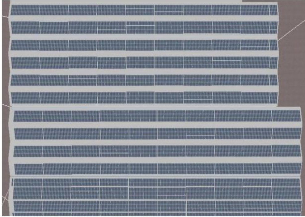
Şekil 4.33. 4 numaralı parselde yer alan sanayi yapısı çatı PV panel yerleşimi
