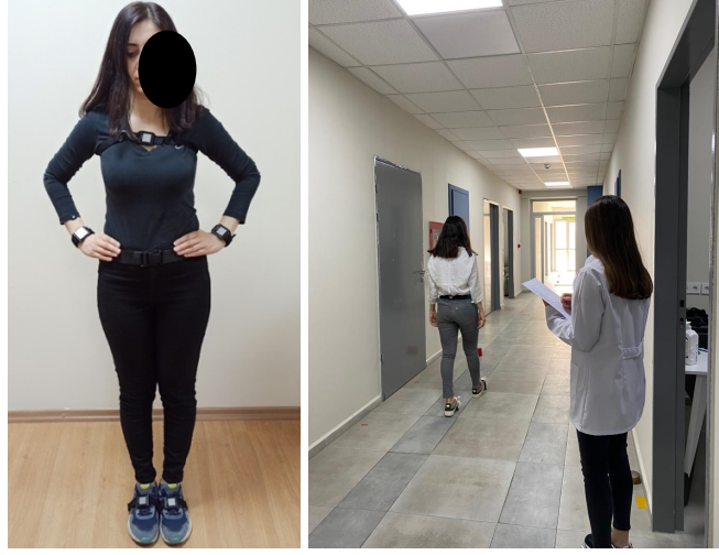
Şekil 2. Üç boyutlu hareket ölçen giyilebilir sensör, sensörlerin yerleştirilmesi ve yürüyüş testi
