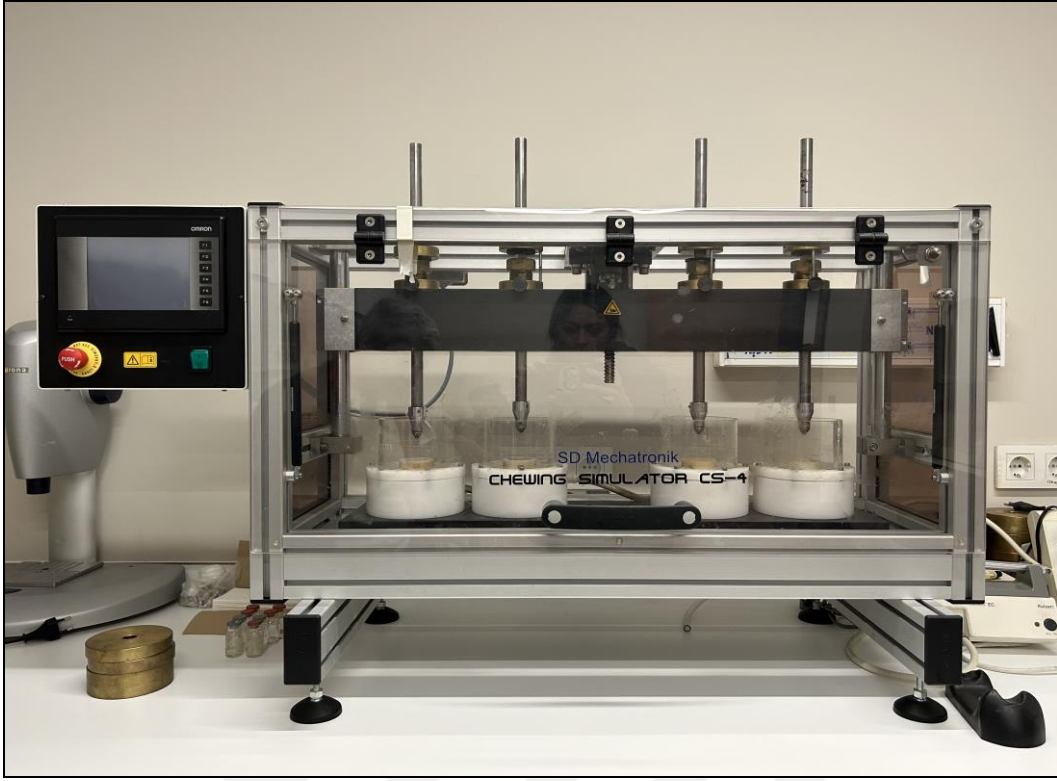
Şekil 3-18: Dual-akslı çiğneme simülatörü (SD Mechatronik Chewing Simülatör CS-4, Willytech, Münih, Almanya)
