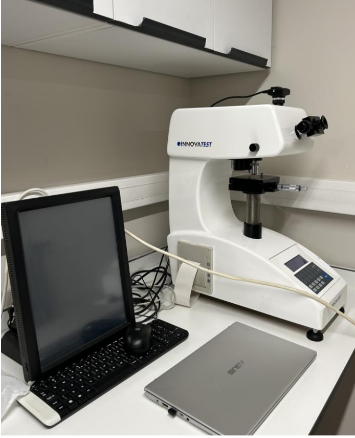
Şekil 3-41: Innova Vickers Sertlik Ölçüm Cihazı, Buehler, ABD
