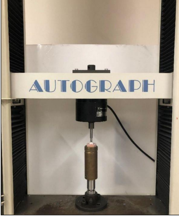
Şekil 3-38: Instron Universal Test Cihazı
