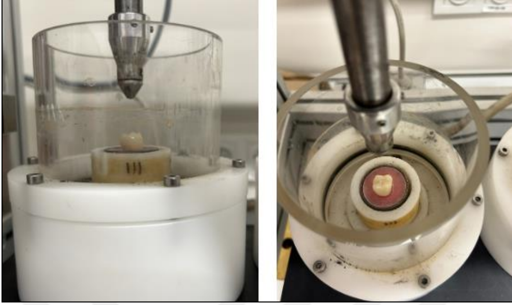
Şekil 3-20: Deney örneklerinin çiğneme simülatöründe konumlandırılması
