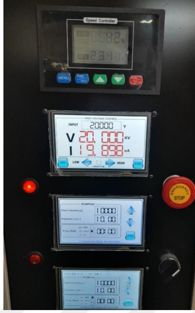
Şekil 4.5. Elektrospinning cihazında voltaj, pompa basınç hızı, tambur döndürme hızı ayarlama paneli
