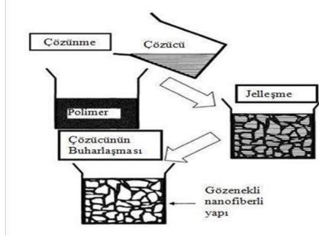
Şekil 2.5. Faz ayrımı metodu ile lif elde edilmesi
