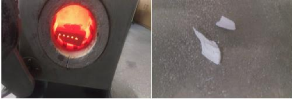
Şekil 4.3. Femur kemiğinin 850 °C derecede pişirme anı ve soğumasından sonrası
