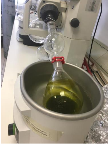
Resim 3. 2: Rotavaporda ekstre solventinin buharlaştırılması işlemi
