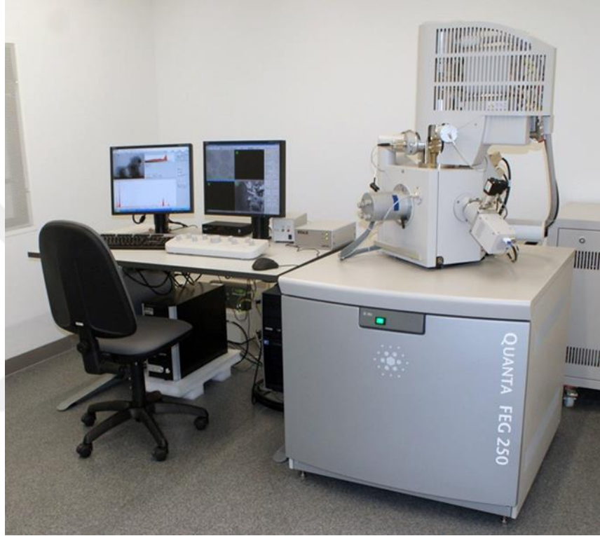
Fotoğraf 5.9. Mikro yapının incelenmesi için SEM görüntüleme cihazı
