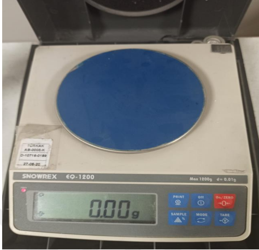
Fotoğraf 5.4. Kalibrasyonu yapılmış hassas terazi
