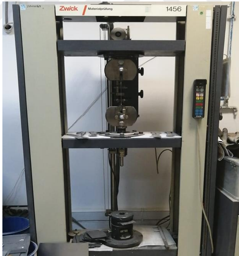
Fotoğraf 5.8. Çekme-Kopma deneyi için bilgisayar kontrollü cihaz
