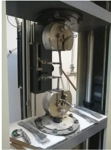
Fotoğraf 5.2. Çekme-kopma deneyi için kalan 321 paslanmaz çelik numune
