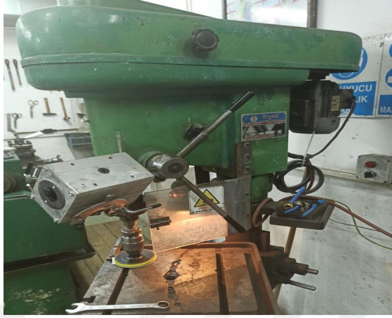
Fotoğraf 5.6. Aşındırma deneyi için kullanılan matkap tezgahı
