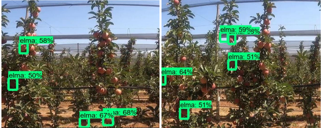
Şekil 4.20. MS COCO veri seti kullanılarak eğitilen FRC modeline ait deneysel elma tespiti çalışmasına ait görüntüler.
