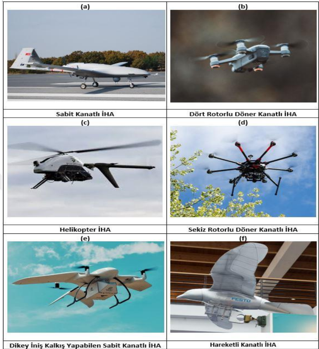
Şekil 2.1. Kanat yapılarına göre farklı tipte İnsansız Hava Araçlarının yapısı.
