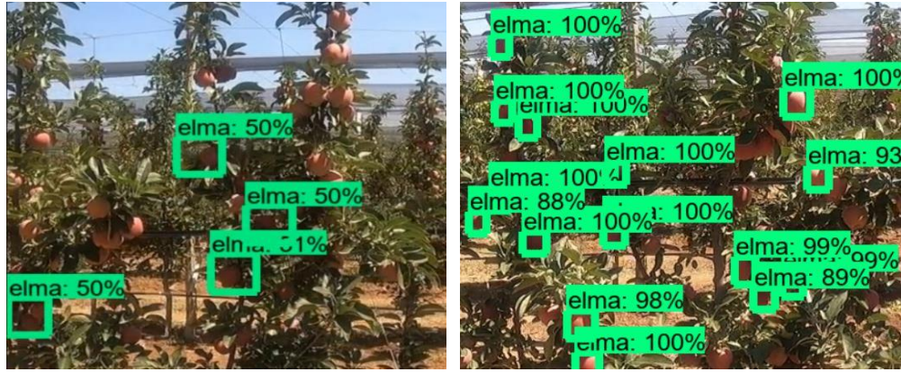
Şekil 3.15. COCO veri seti (soldaki) ve özgün veri setiyle (sağdaki) eğitilen sinir ağ model ile gerçekleştirilen elma tespiti.
