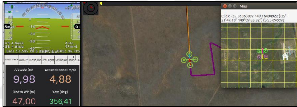
Şekil 4.1. Simülasyon ekranında URS’nin otonom yörünge takibi.
