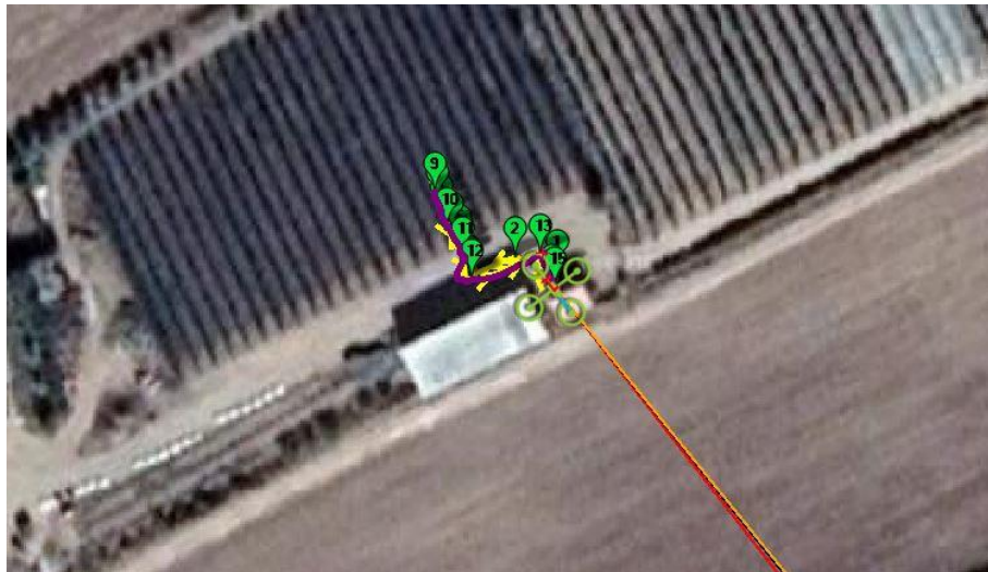
Şekil 4.16. Otonom uçuşta izlenen yörünge uydur haritası üzerinde görünümü.
