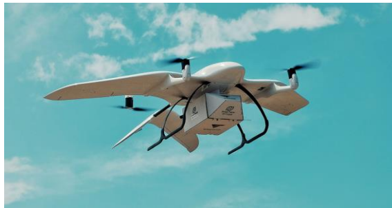
Şekil 2.4. Dikey iniş-kalkış yapabilen sabit kanatlı İHA yapısının görünümü [43].
