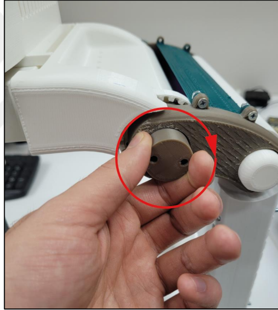
Şekil 4.5 Kinematik Bağlantı Kilit Sisteminin Serbest Bırakılması
