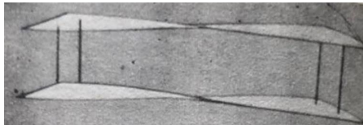
Görsel 17: Wright Kardeşlerin bükülerek kontrol imkânı sağlayan çift kanatlı uçak kanadı (Atom,1986.30)
