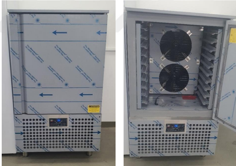
Şekil 3.9. Tez çalışması kapsamında kullanılan hava akımlı dondurucu sistem
