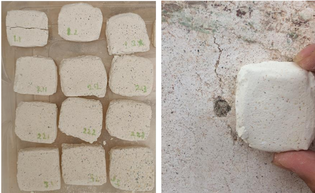
Resim 6.5. Intonacco harcı denemeleri ve en uygun harcın özün harç ile karşılaştırılarak belirlenmesi (Ephesos Yamaç Ev 2 Koruma-Onarım Projesi Arşivi).
