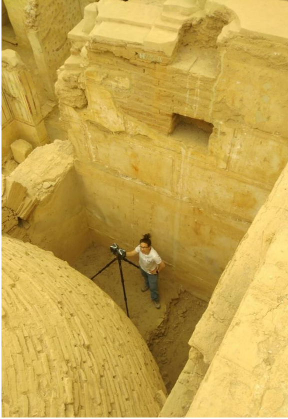
Resim 4.20. 2022 yılı, Yamaç Ev 2 konut birimlerinde yersel lazer ile tarama uygulamaları (URL 9).
