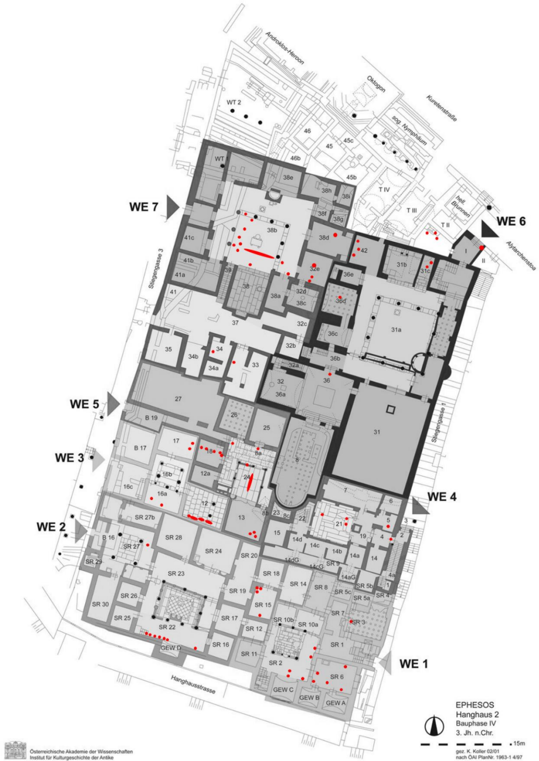
Şekil 5.3. Yoğuşmayla örtüde toplanan suyun konut mekanları zeminine damladığı tespit edilen bazı alanlar (Şekil 3.1 üzerine işlenmiştir).
