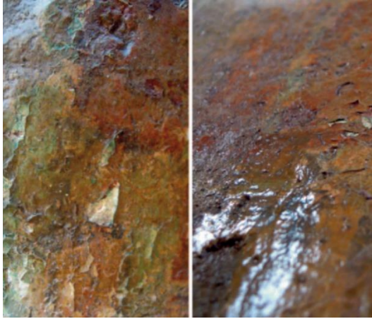
Resim 6.4. Paraloid B72'nin yüzey koruyucu- sağlamlaştırıcı olarak uygulandığı duvar resminde, reçinenin bozulmasını takiben yol açtığı renk değişikliği ve yüzey kaybı (Baglioni vd., 2015, s. 19).
