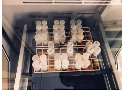
Şekil 3.4. Shakerda (IKA KS 4000 i control) mutagen uygulanması
