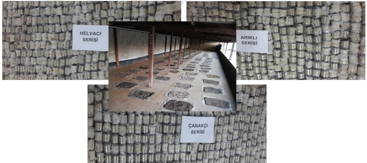
Şekil 3.7. Bozulmuş ve bozulmamış toprak örneklerinin analize hazırlanması
