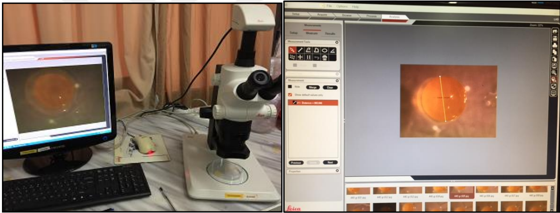
Şekil 3.7: Alınan yumurta örneklerinde yumurta çaplarının ölçülmesi
