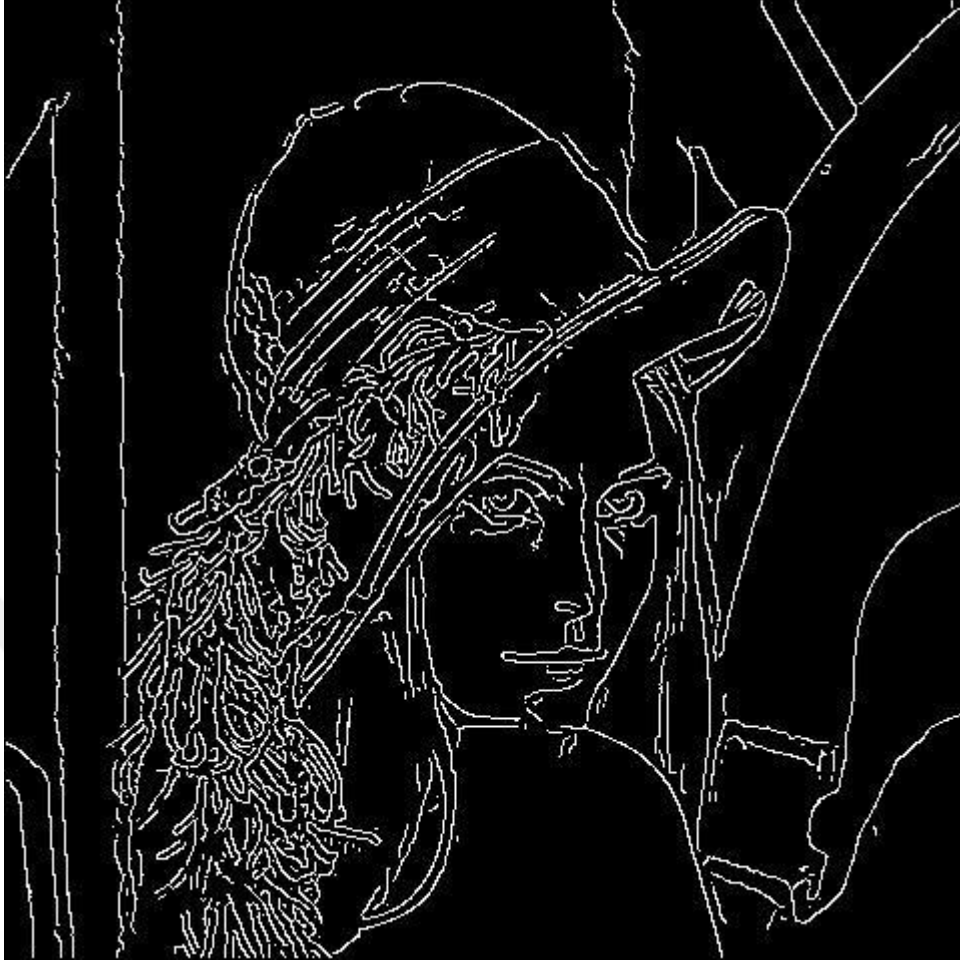
Şekil 2.16: Canny kenar belirleme filtre çıktısı [25]
